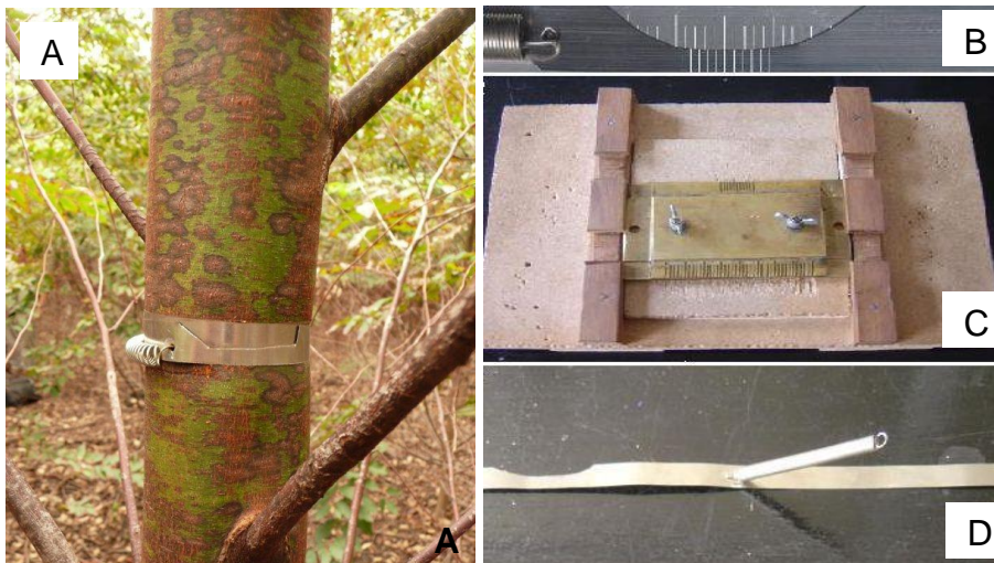
Figura 4 - Confeção e instalação da faixa dendrométrica no tronco da árvore. (A) faixa dendrométrica no tronco da árvore, (B) sobreposição da escala e do nônio, (C) gabarito para gravação da escala e do nônio, (D) detalhe da faixa dendrométrica com a escala e a mola. Adaptado de Sette Junior (2010) e Castro (2014)
