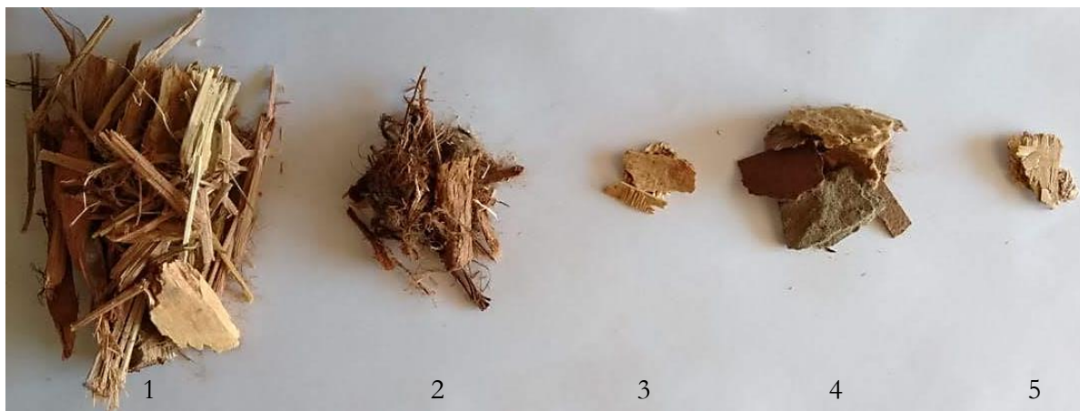
Figura 2.2 – Exemplo de separação de material reprocessado - (1)madeira sólida (2)casca (3)compensado (4)MDF (5)aglomerado
