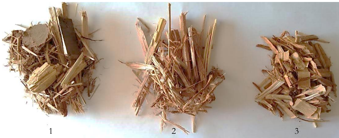
Figura 2.1 – Exemplo de material coletado na empresa C- (1)cavaco de resíduos madeireiros reprocessados/CAV C, (2)cavaco de palete/Palette C e (3)cavaco de eucalipto/Euca C
