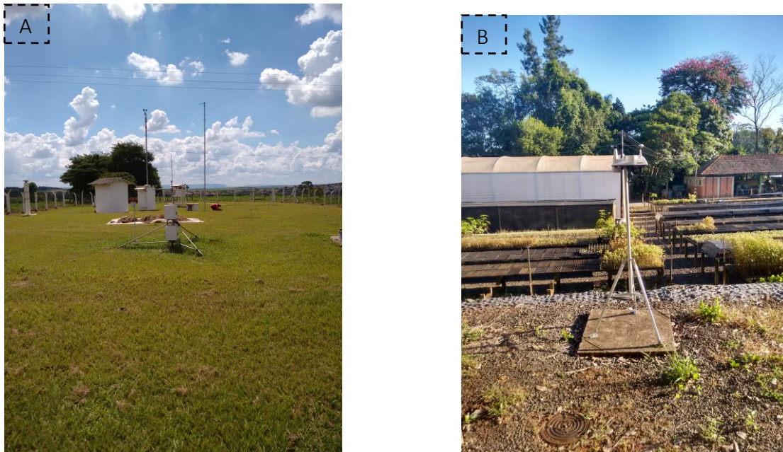
Figura 17A: Posto Agrometeorológico da ESALQ/USP e Figura 17B: Estação DAVIS VANTAGE VU instalada no Departamento de Ciências Florestais da ESALQ/USP
