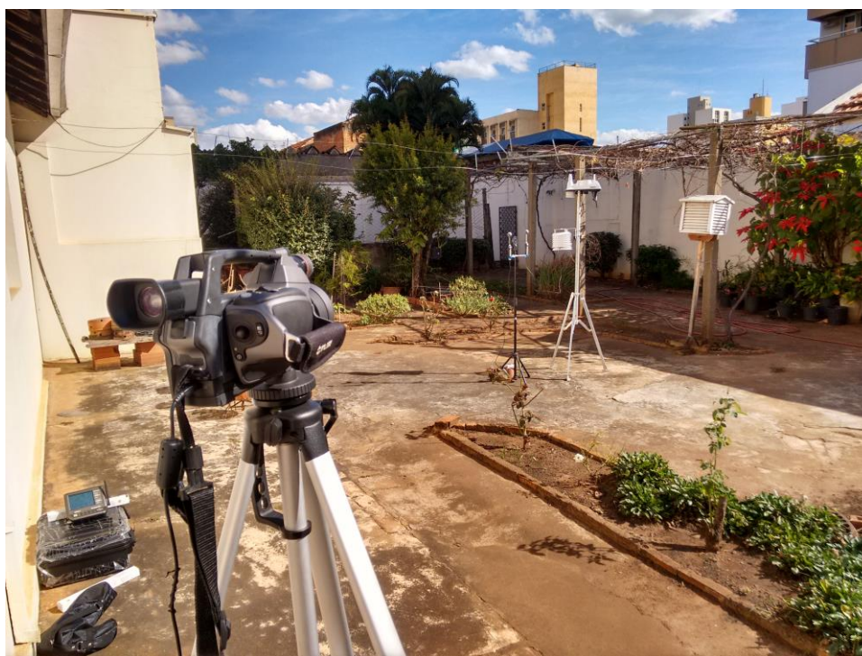
Figura 14: Disposição da estação meteorológica DAVIS Vantage Vu, câmera FLIRSC660 e termômetro de globo da marca TESTO 175T2, instalados no bairro Cidade Alta a 1,5 m do solo
