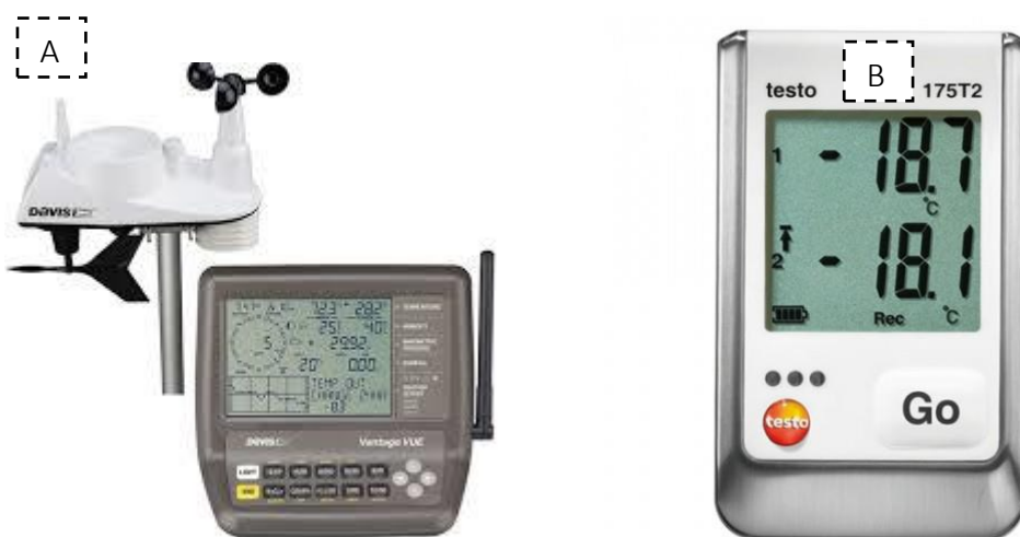
Figura 13: (A) Estação meteorológica DAVIS Vantage Vu. (B) Termômetro de globo da marca TESTO 175T2, ambos instalados a 1,5 m a partir do solo
