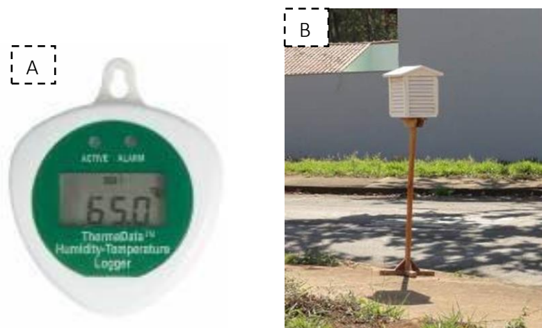
Figura 12: (A) Registrador de temperatura e umidade relativa do ar ThermaData. (B) Abrigo meteorológico confeccionado de madeira tipo veneziana, pintado de branco com pé de 1,5m a partir do solo
