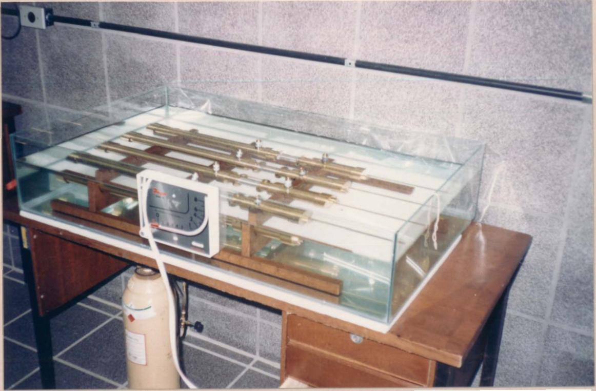
Figura 24. Recipiente de vidro contendo as células de difusão imersas em água, durante determinação do coeficiente de difusão.
