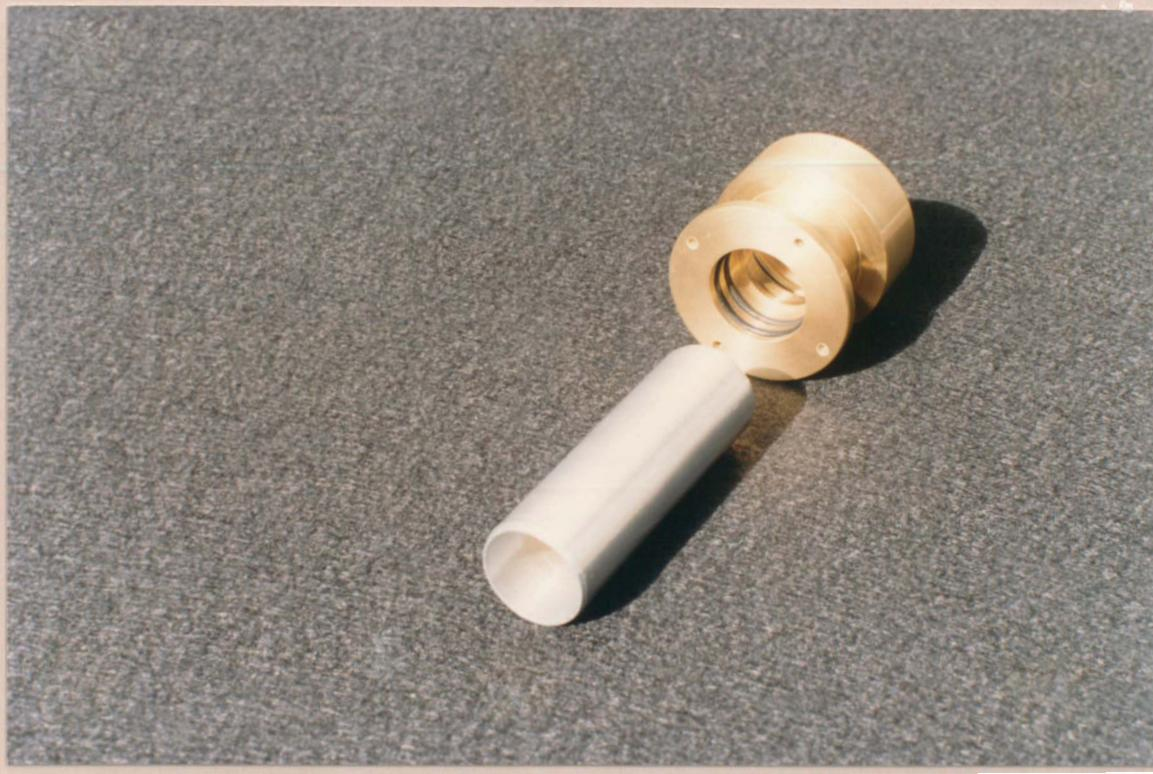
Figura 16. Detalhe de um dos cilindros de alumínio onde foi colocado o material granular do Cambissolo, para a formação dos meios porosos, e da peça onde foi conectado.
