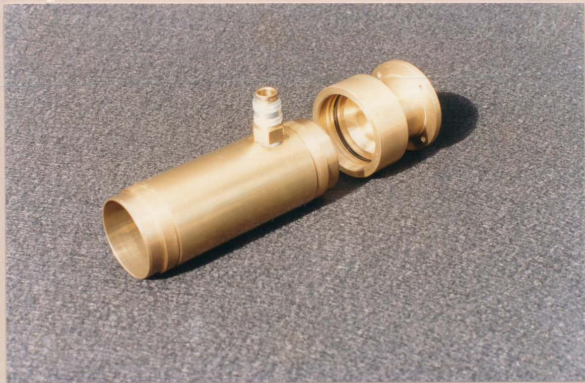
Figura 17. Detalhe da peça que forma a câmara de entrada da célula de difusão, onde se pode ver a conexão de engate do manômetro diferencial.
