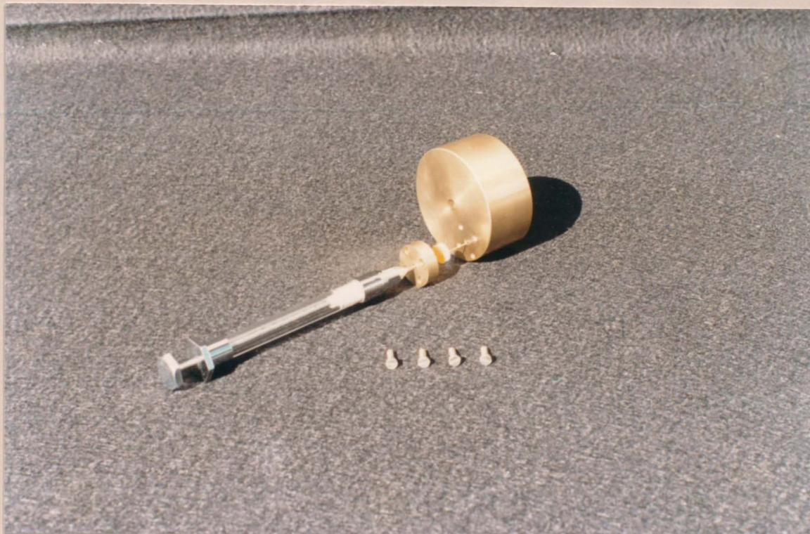
Figura 20. Detalhe do orifício para coleta de amostras de gás na tampa da câmara de entrada e de seu sistema de vedação, provido de um disco de silicone.
