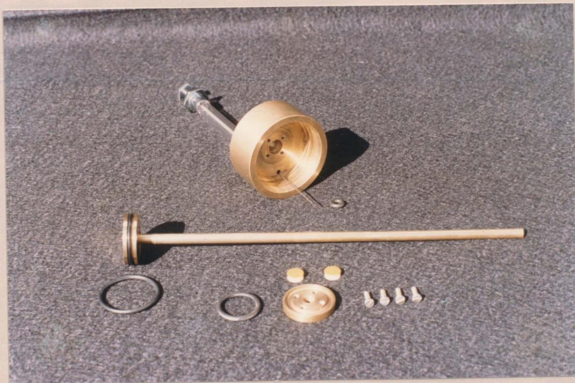
Figura 19. Conjunto de peças que formam a tampa da câmara de entrada da célula de difusão e detalhe do posicionamento da seringa usada para retirada de amostras gasosas.
