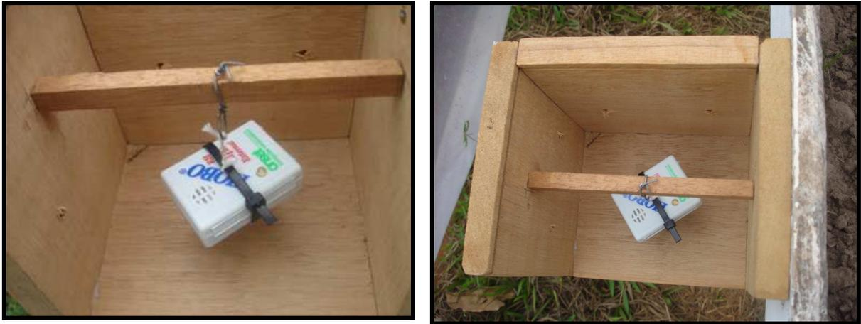
Figura 7 - Posicionamento do *data logger* em campo para coleta de dados meteorológicos
