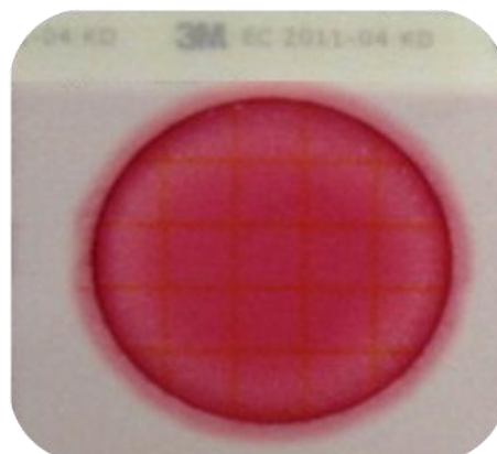
Figura 27 – Placa 3M™ Petrifilm™ para Contagem de Coliformes (EC). Sem crescimento de coliformes em amostras de salame tipo Italiano
