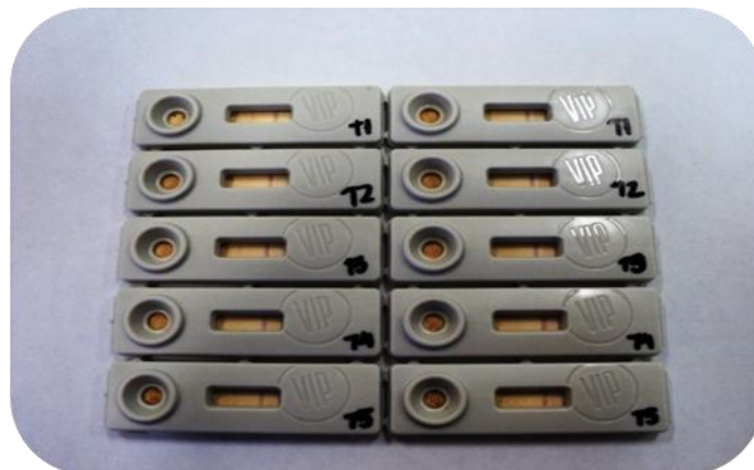
Figura 26 – Kit VIP® para Salmonella . A presença de 1 faixa vermelha no retângulo indica a negatividade de sua presença em 25 g de amostra analisada
