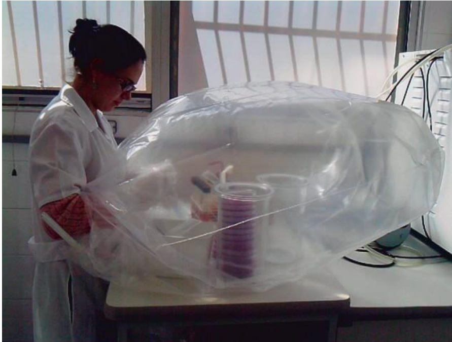
Figura 9 - Sistema de anaerobiose Glove bag TM modelo X-37-27
