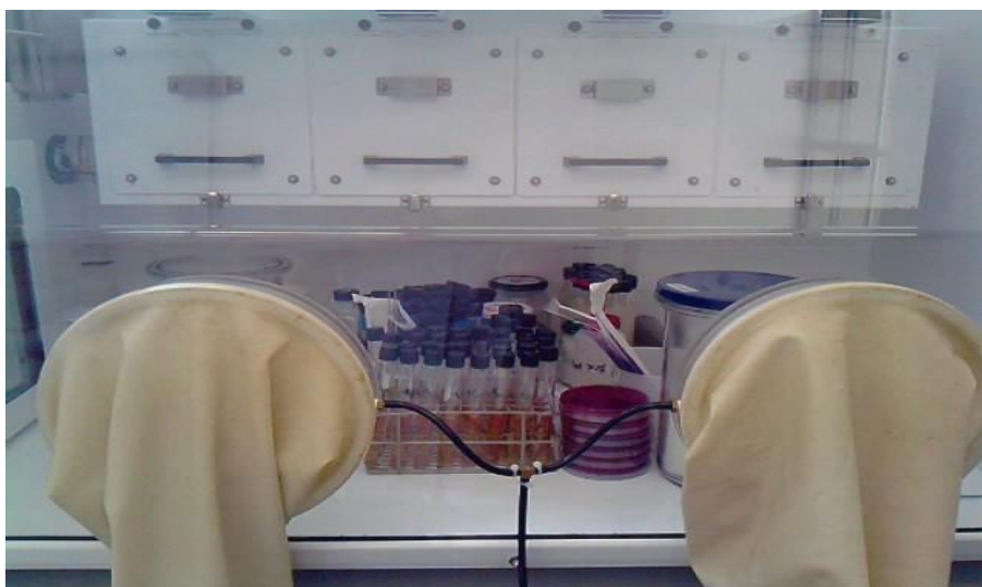
Figura 10 – Câmara anaeróbica Shell lab TM modelo Bactron II Chamber
