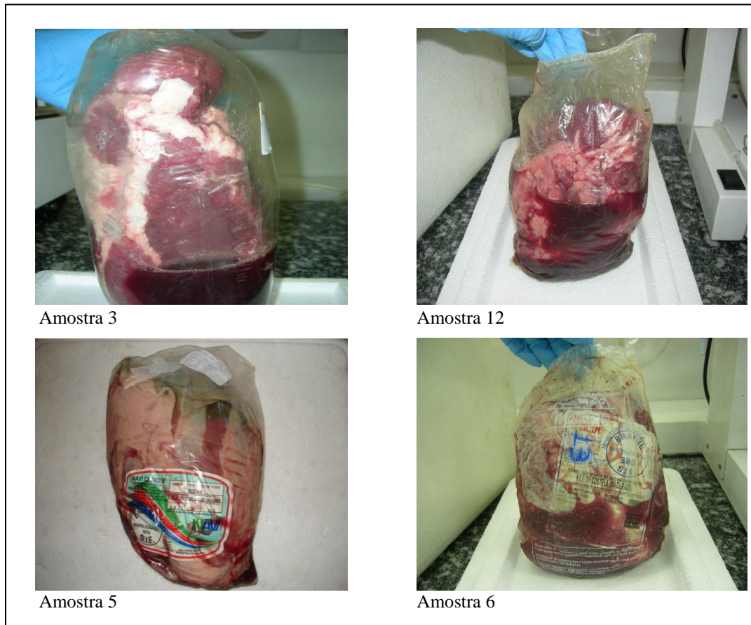
Figura 4 – Exemplo de quatro amostras de carnes embaladas a vácuo com embalagens distendidas
