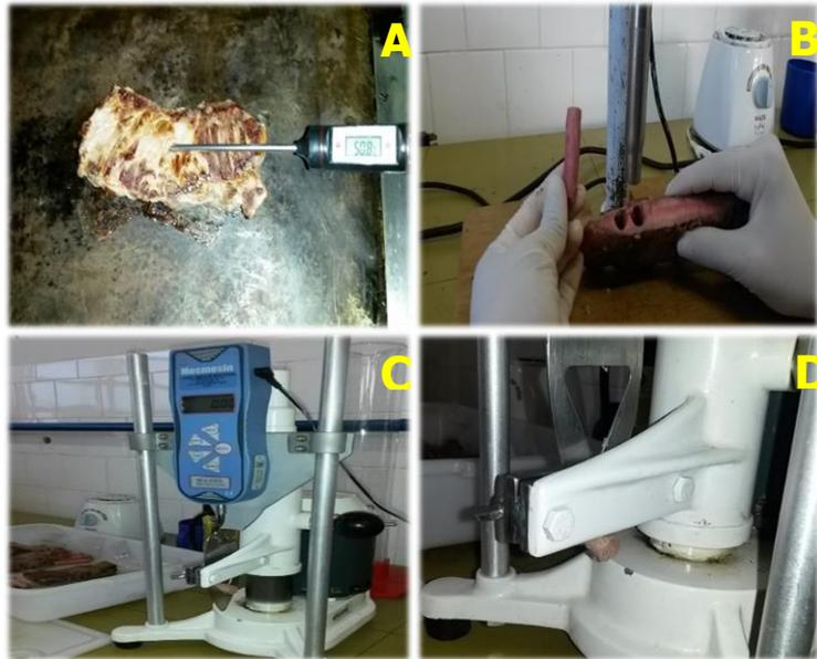
Figura 6 - Análise de força de cisalhamento Warner–Bratzler. A) Controle da temperatura de cozimento; B) Remoção de peças cilíndricas; C) Texturômetro acoplado a lâmina Warner–Bratzler; D) Corte das amostras com a lâmina
