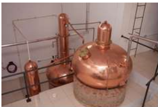
Figura 6 - Alambique utilizado para a produção das aguardentes
