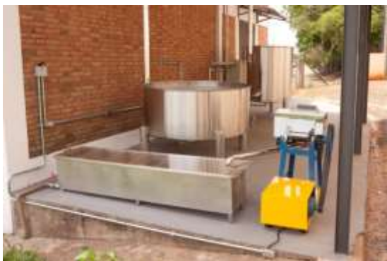
Figura 7 - Setor de extração e tratamento do mosto de caldo e de xarope.
