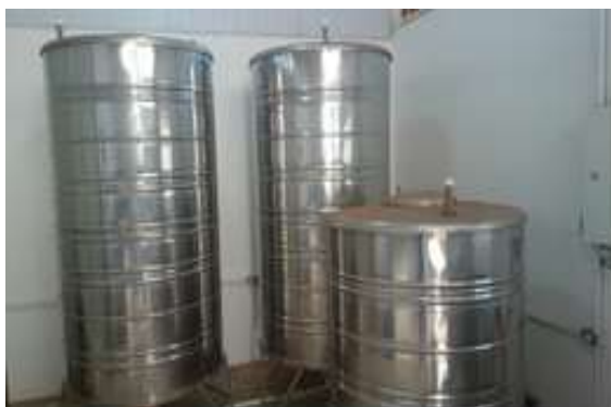
Figura 9 - Tanques de aço inoxidável destinados ao armazenamento dos flegmas oriundos da primeira destilação do processo de produção da aguardente bidestilada.
