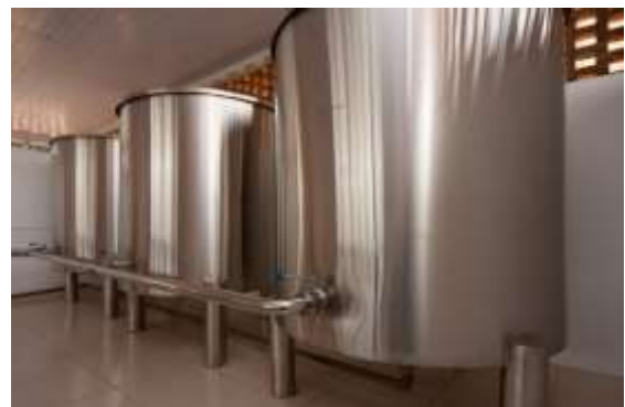
Figura 8 - Setor de fermentação, com dornas de aço inoxidável
