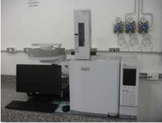
Figura 10 - Cromatógrafo a gás com detector de ionização de chama
