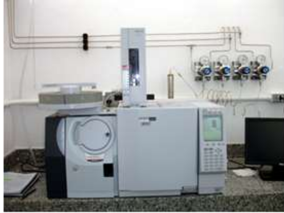
Figura 11 - Cromatógrafo a gás com detector de massas
