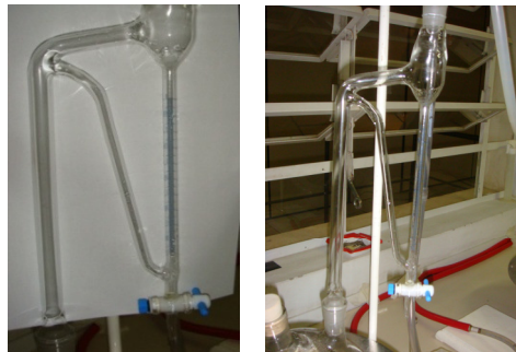
Figura 2 – Dean Stark graduado com capacidade de 5 mL
