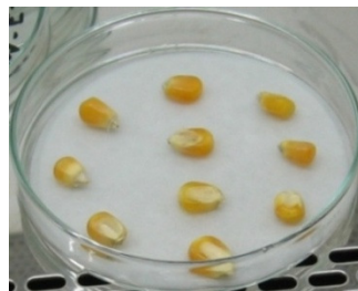
Figura 4 - Disposição dos grãos de milho sobre o papel de filtro umedecido e acomodado na placa de Petri
