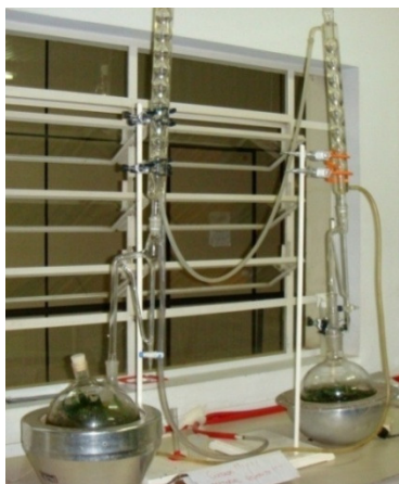
Figura 3 - Equipamento tipo Clevenger utilizado para extração do óleo
