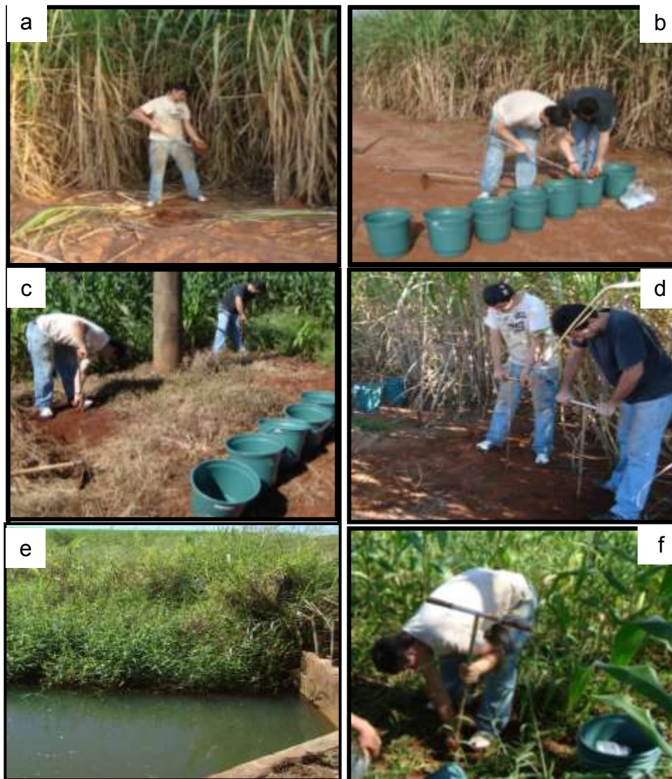
Figura 5 – Fotos das coletas de solo da Bacia do Guamium realizada em fevereiro de 2012, Piracicaba, SP. (a) coleta de solo próximo à área de cana-de-açúcar; (b) separação das amostras de solos coletadas em diferentes profundidades; (c) amostragem de solo próximo à área de milho; (d) amostragens em diferentes profundidades; (e; f) amostragem de solo próxima ao ribeirão Guamium
