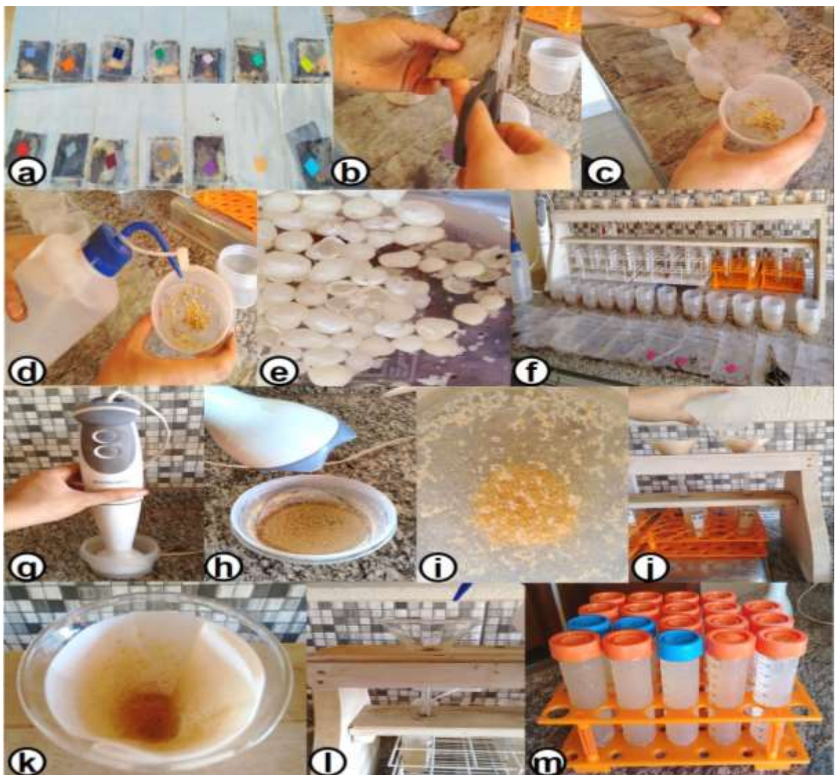
Figura 19. Preparo das amostras provenientes do experimento de liberação dos fertilizantes nitrogenados; a=amostras descongeladas acondicionadas em sacos plásticos; b=abertura das bolsas porosas; c=retirada dos grânulos da bolsa porosa para desintegração; d=adição de H 2 O deionizada para desintegração em meio aquoso; e=detalhe grânulos anterior a desintegração; f=mesa de filtragem e amostras prontas para desintegração; g=processo de desintegração; h=finalização da desintegração; i=detalhe da amostra desintegrada e material residual das cápsulas de recobrimento; j=processo de filtragem da amostra; k=material residual da filtragem; l=lavagem do filtro para solubilização de solução residual; m=material preparado e acondicionado em tubos Falcon (50mL)
