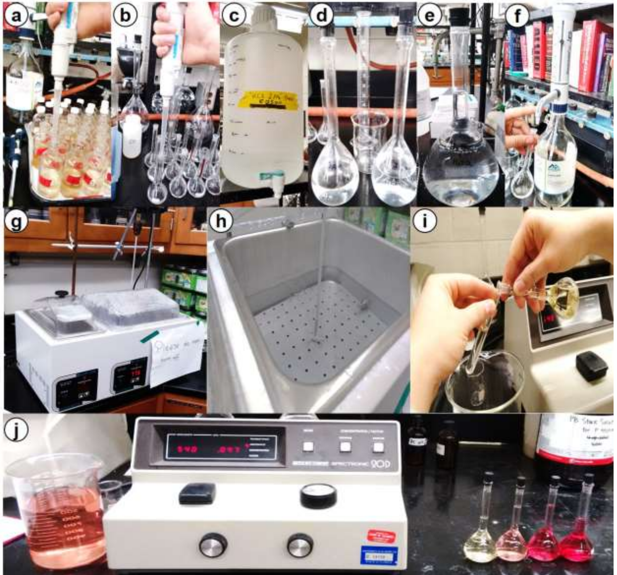
Figura 8. Procedimentos de análise de N-ureia do experimento de fracionamento do nitrogênio proveniente da ureia convencional e com inibidores de urease; a=extrato de solo; b=pipetagem da alíquota do extrato do solo; c, d, e, f preparação e aplicação do reagente de cor; g=Banho Maria; h=detalhe do Banho Maria - hélice de agitação para manutenção da homogeneidade térmica; i=cubeta do colorímetro; j=equipamento colorimétrico para leitura das absorbâncias das amostras
