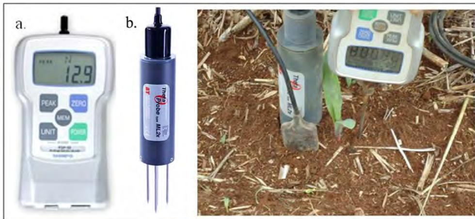
Figura 2 – Equipamentos utilizados em campo: medidor de força da fabricante Shimpo (a) para medir a resistência à penetração (kgf) e, sensor de umidade ML2x da fabricante Delta-T (b) para determinação do conteúdo volumétrico de água no solo ( $m^3 m^{-3}$ )
