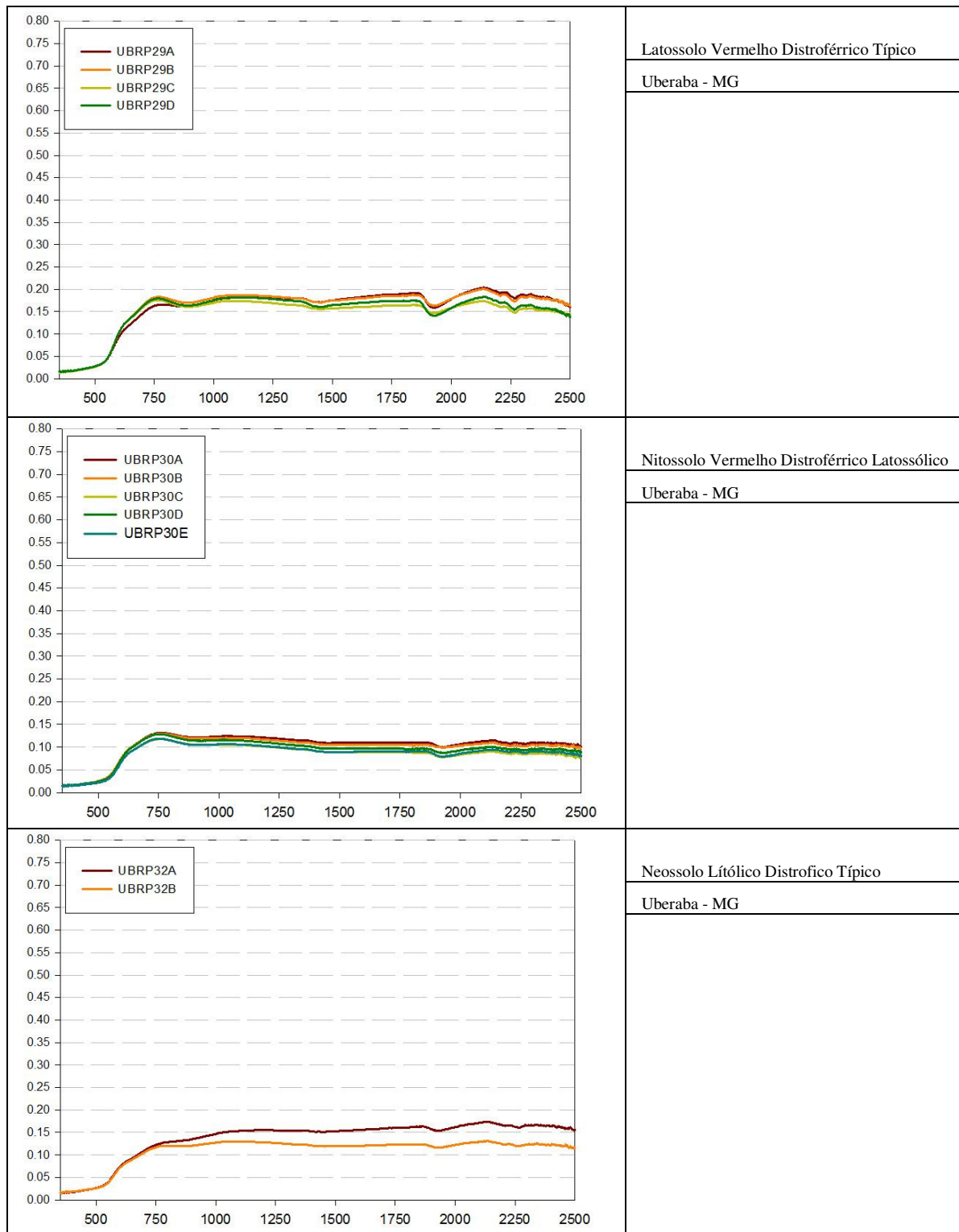
Figura 3.62 – Curvas espectrais dos perfis de solos da região de Uberaba-MG
