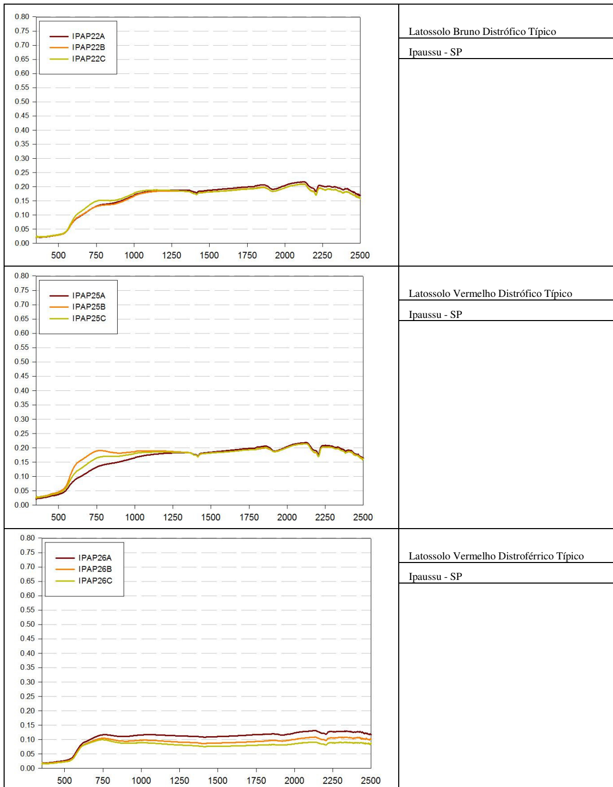
Figura 3.23 – Curvas espectrais dos perfis de solos da região de Ipaussu, SP
