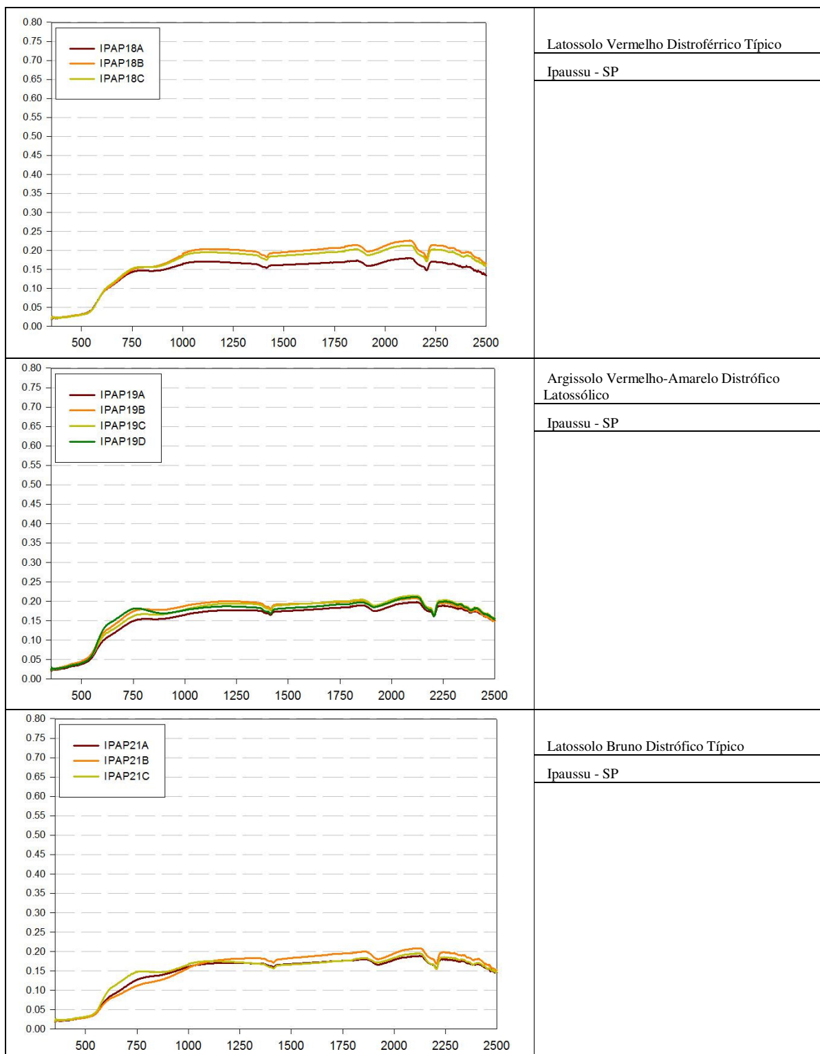
Figura 3.22 – Curvas espectrais dos perfis de solos da região de Ipaussu, SP
