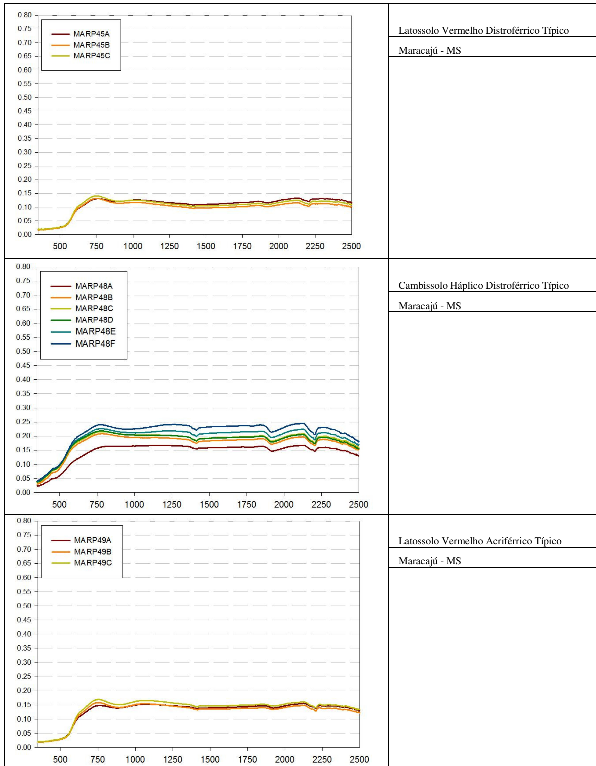
Figura 3.40 – Curvas espectrais dos perfis de solos da região de Maracajú, MS
