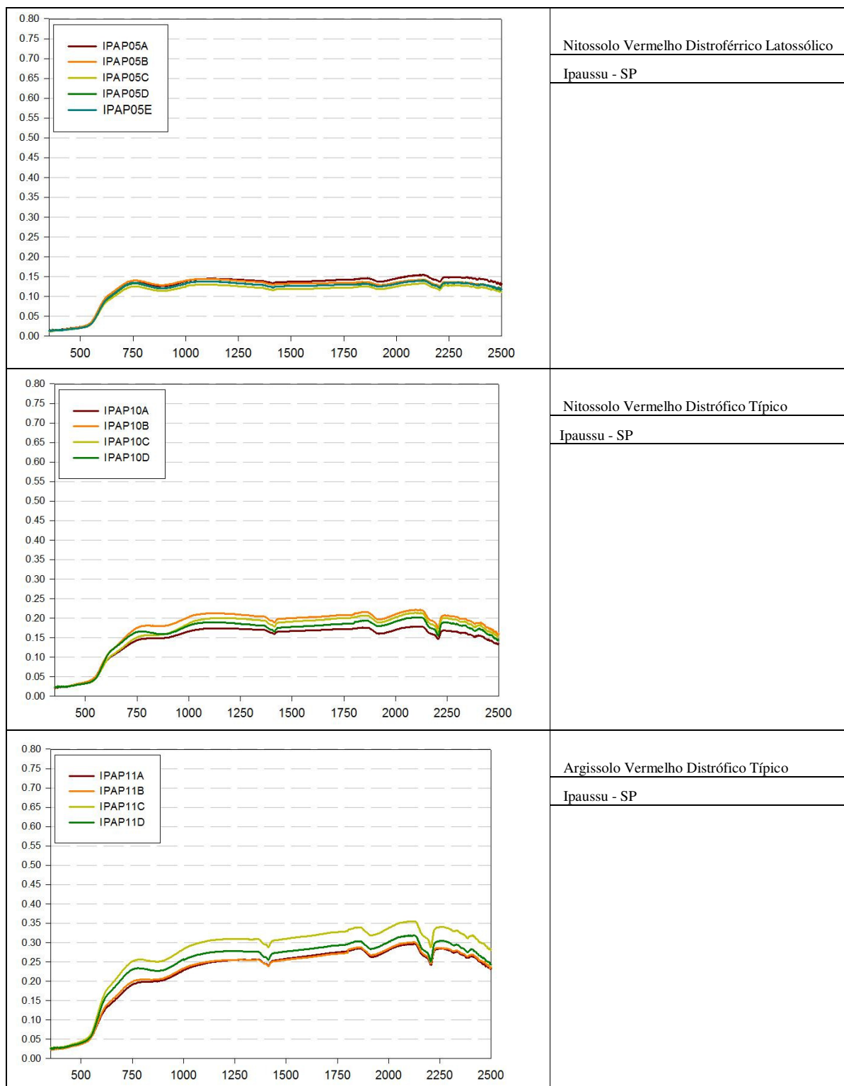
Figura 3.20 – Curvas espectrais dos perfis de solos da região de Ipaussu, SP
