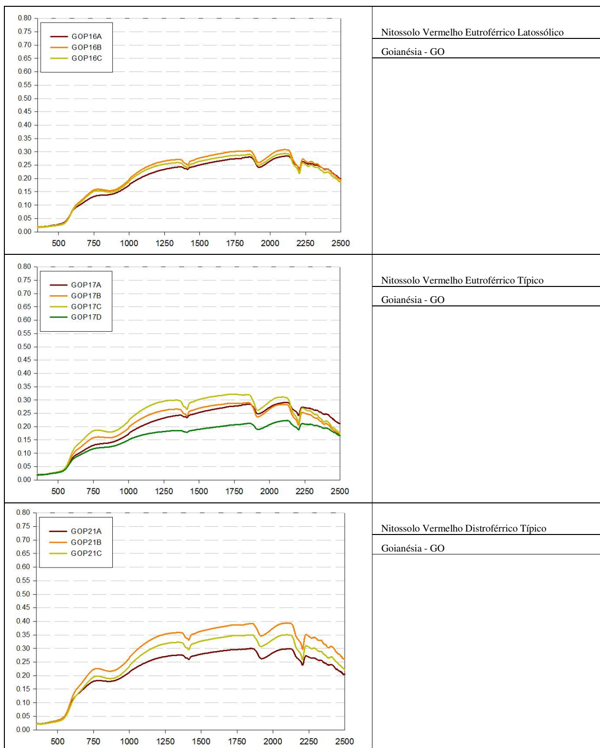
Figura 3.49 – Curvas espectrais dos perfis de solos da região de Goianésia-GO
