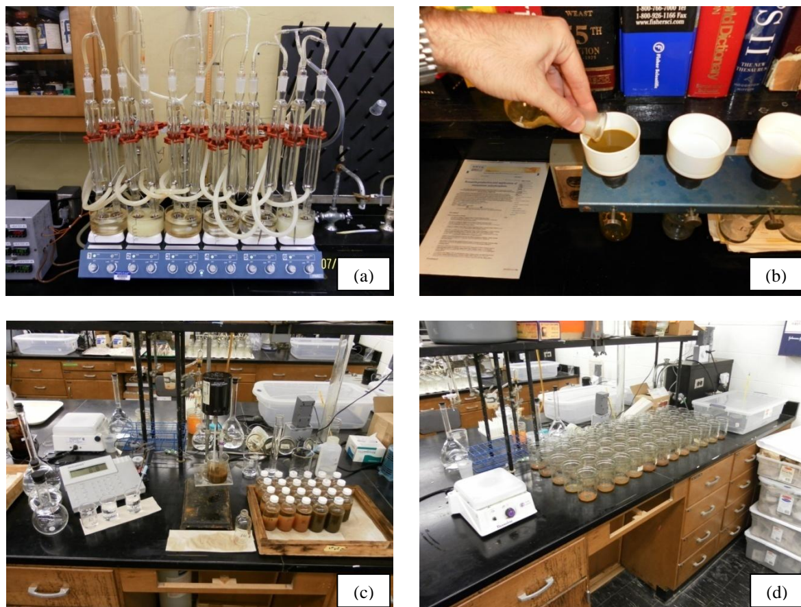
Figura 4 - Condensador de Liebig para aquecimento das amostras de solo sob refluxo, com dispositivo para manter a temperatura dos 6 conjuntos a 110°C (a); processo de filtragem do hidrolisado após resfriamento da amostra (c); neutralização das amostras para obtenção de pH entre 6,5 e 6,8 e detalhes das amostras após adição de água desionizada até completar 100 mL (c) e transferência das amostras para as câmaras de difusão para os procedimentos de fracionamento do N orgânico conforme Mulvaney e Khan (2001)
