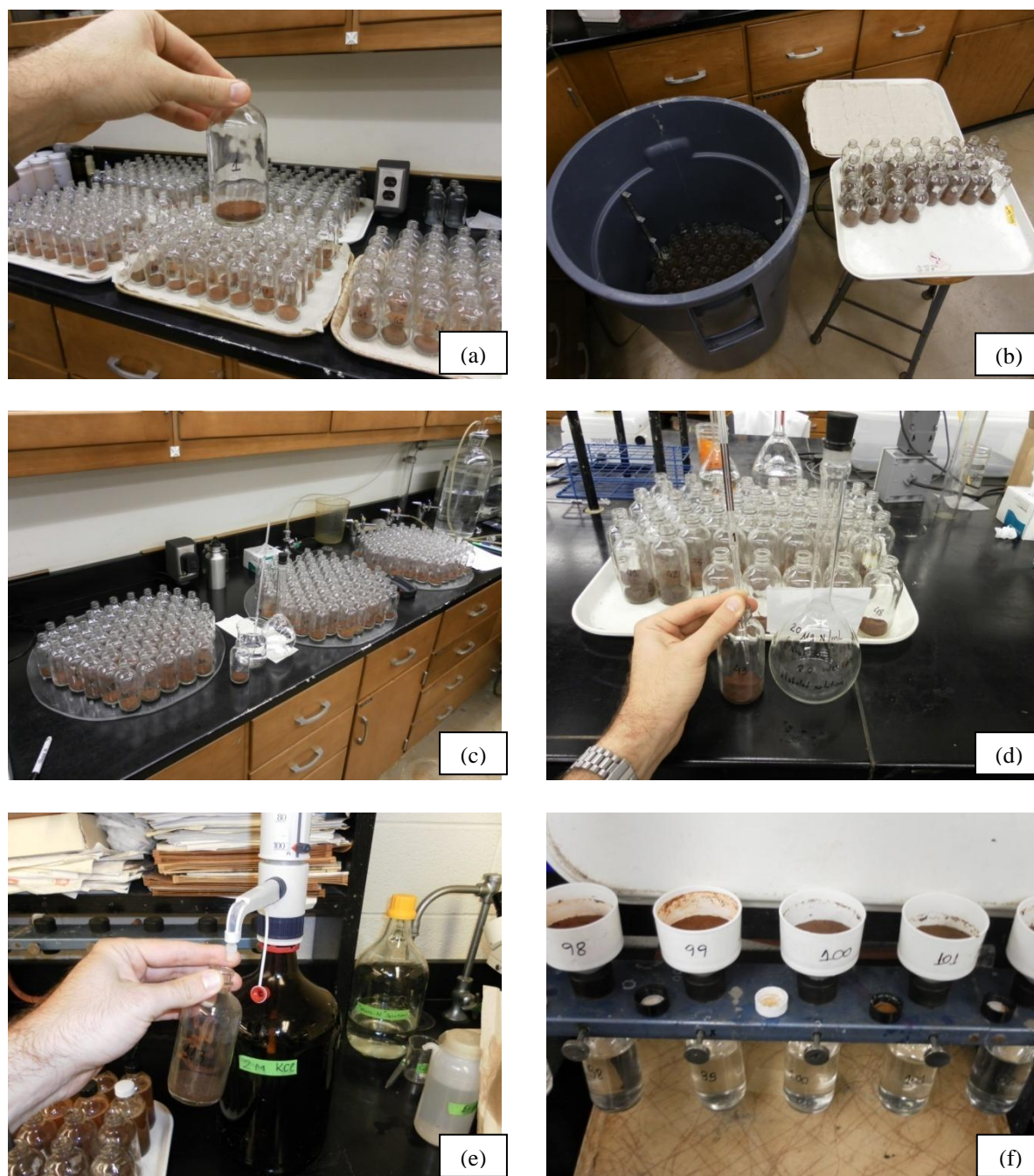
Figura 5 - Detalhes dos frascos de vidro (125 mL) contendo as amostras de solo (10 g) utilizadas no experimento de mineralização bruta (a); amostras sendo dispostas no incubador com sistema de injeção de vapor de água para manutenção da temperatura da umidade relativa a 85-90% (b); após a pré-incubação, as amostras receberam 1,5 mL de solução contendo ^{15}\text{N} com auxílio de pipeta volumétrica (c e d) e retornaram ao incubador; amostras recebendo 100 mL de 2 M KCl para posterior agitação por 1 h para extração do N inorgânico (e); processo de filtragem sob vácuo do extrato utilizando filtro de microfibras de vidro em funis de Buchner de polipropileno (5,5 cm de diâmetro) (f)
