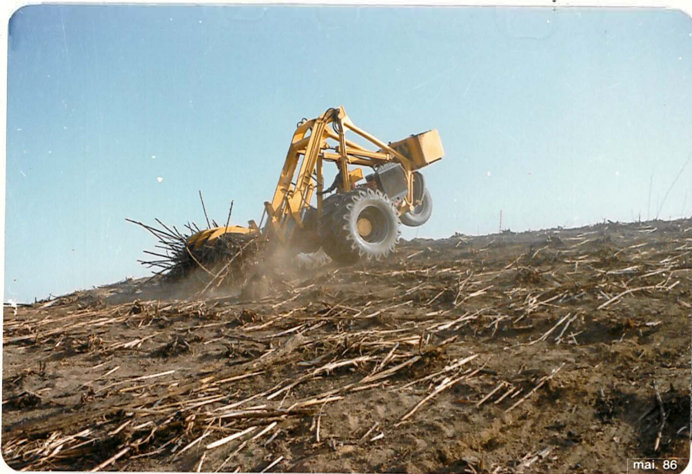
Fig. 5 - Carregadora em operação, dirigindo-se de ré à unidade de transporte, na série de ensaios em relevo de encosta.
