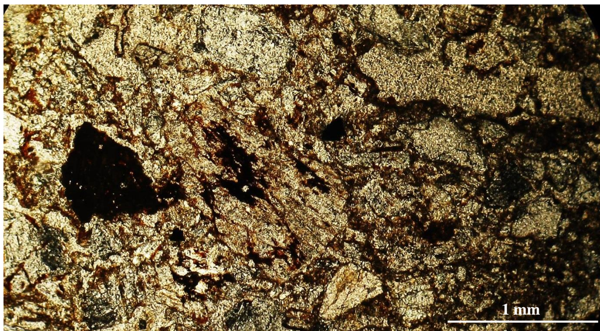
Figura 28 - Perda da estrutura e da isovolumetricidade microscópica diante da redistribuição de partículas na região isovolumétrica de P5. PPL
