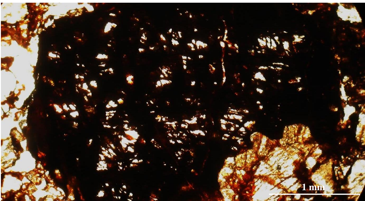
Figura 33 - Precipitado oxidado acumulando-se através dos planos de clivagem de microclina na região isovolumétrica de P10
