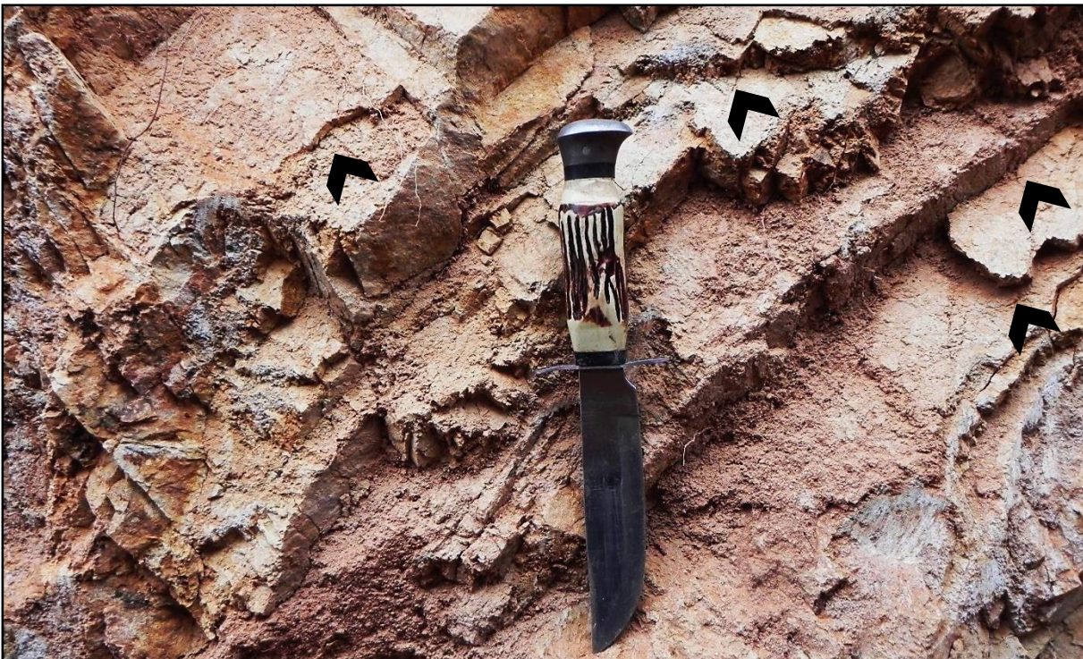
Figura 10 - Foto demonstrando a presença de esfoliação da estrutura derivada de sienito do horizonte saprolitogênico SR em P10
