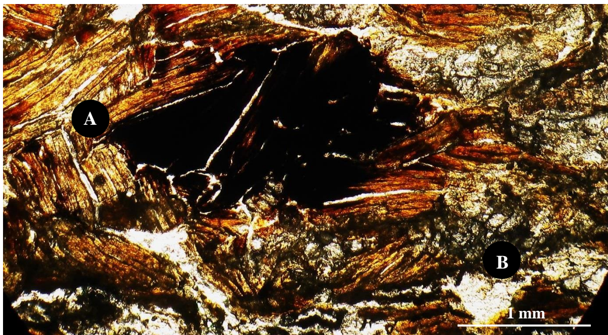
Figura 12 - Planos de foliações (A) e fraturas planares (B) com ausência de preenchimento ou revestimento no horizonte 2Cr2/SC em P12. PPL
