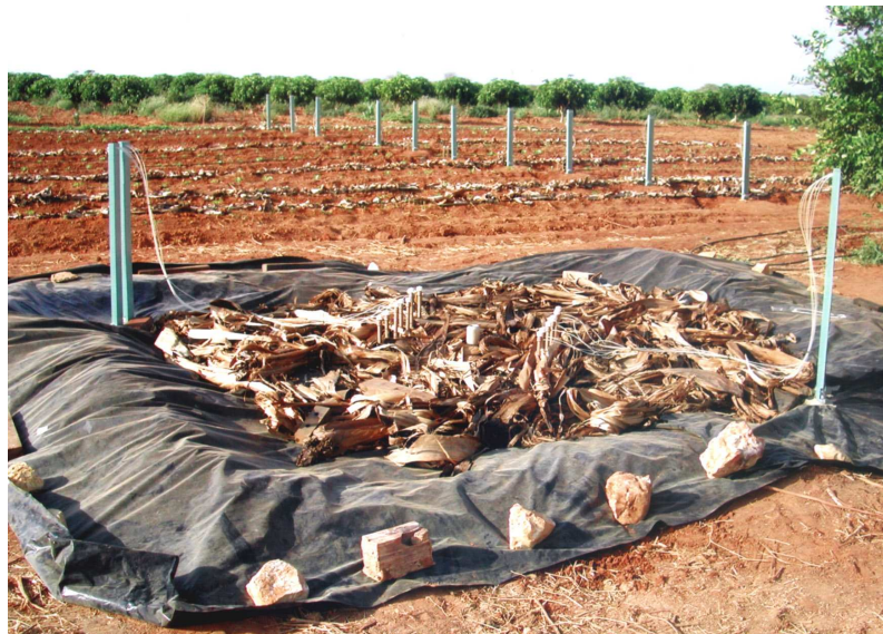
Figura 1 - Parcela para a determinação da condutividade hidráulica do solo
