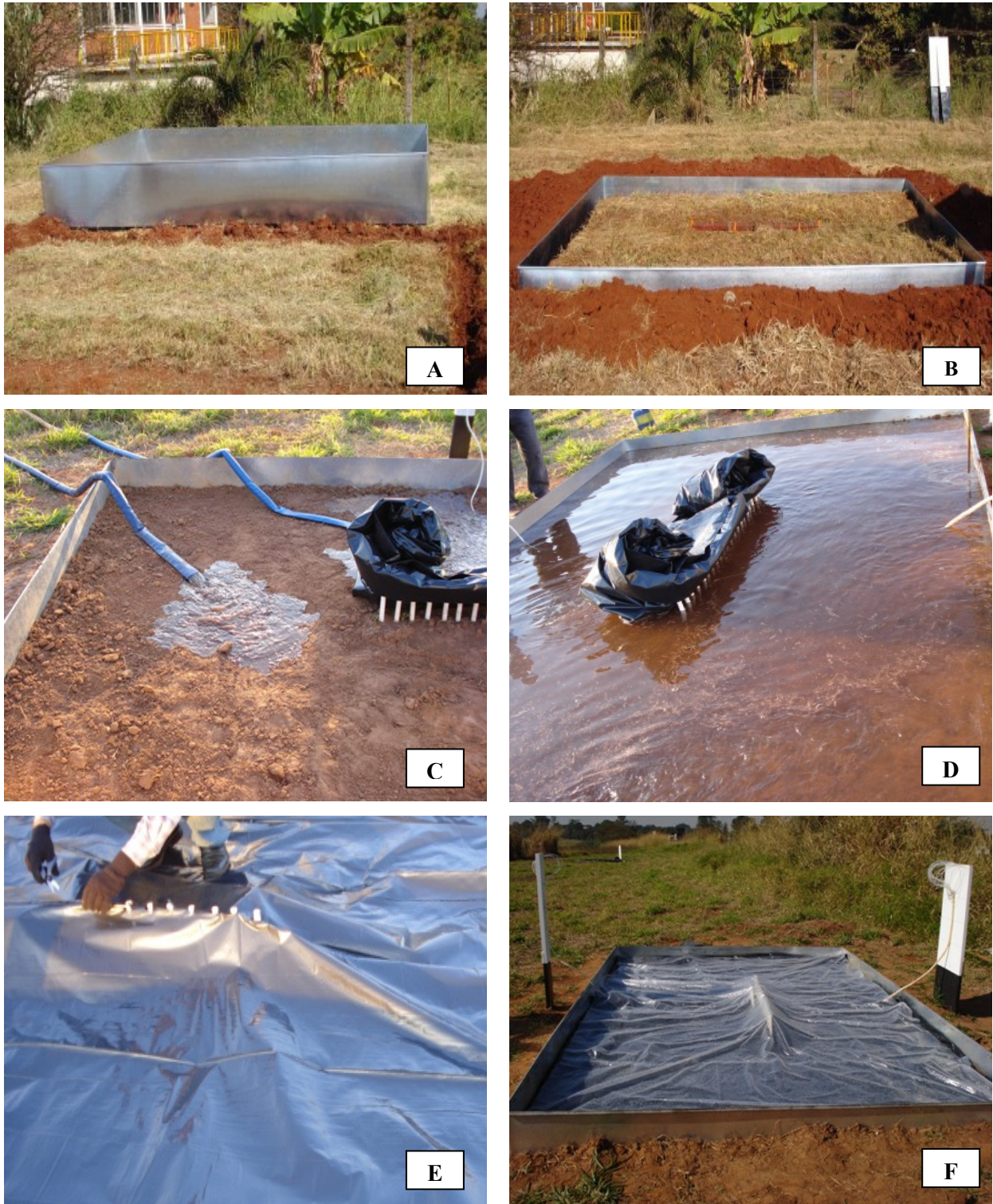
Figura 6 – Instalação da estrutura de chapa galvanizada (A e B), inundação da parcela (C e D), colocação da lona (E) e do plástico bolha (F)
