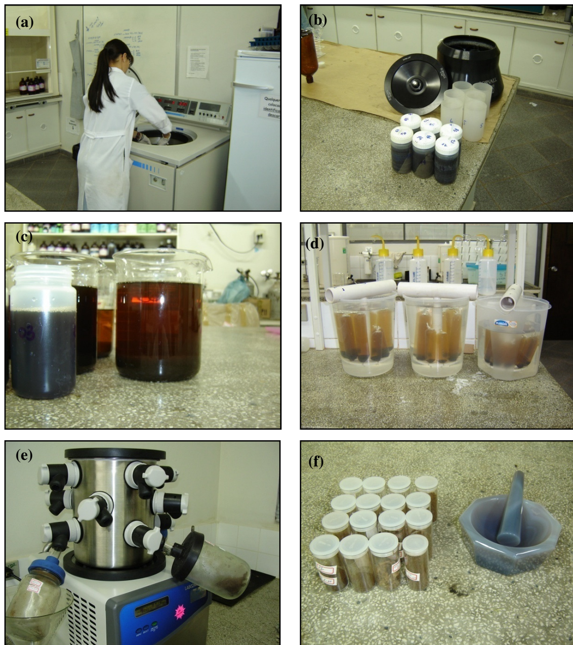
Figura 6 – Fotos ilustrativas do fracionamento químico das SH. (a) Processo de centrifugação; (b) amostras centrifugadas; (c) ácido húmico precipitado + ácido fúlvico; (d) diálise das amostras; (e) liofilização das amostras e (f) amostras liofilizadas e prontas para serem moídas em almofariz de ágata para posteriores análises espectroscópicas
