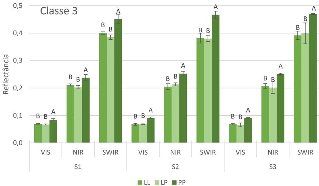
Figura 9- Valores médios de reflectância da Classe 3 para comparação entre geometrias em um mesmo sensor para cada região espectral. Letras iguais significam valores iguais (5% de significância) dentro de cada sub-marcação
