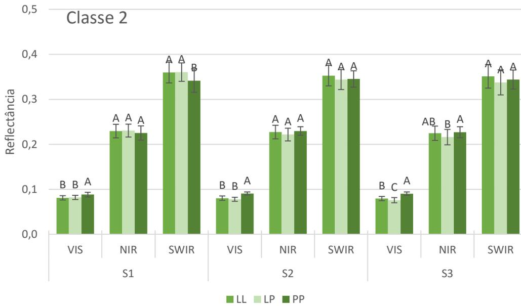
Figura 13 - Valores médios de reflectância da **Classe 2 após padronização** para comparação entre geometrias em um mesmo sensor para cada região espectral. Letras iguais significam valores iguais (5% de significância) dentro de cada sub-marcação
