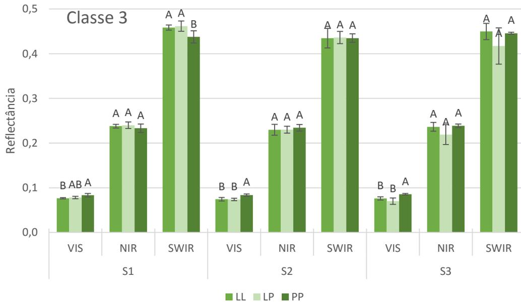
Figura 15 - Valores médios de refletância da **Classe 3 após padronização** para comparação entre geometrias em um mesmo sensor para cada região espectral. Letras iguais significam valores iguais (5% de significância) dentro de cada sub-marcação
