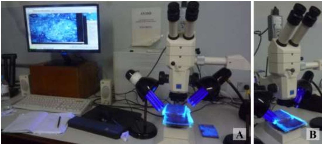
Figura 3.3 - Material para realização da análise micromorfométrica. A. Captura de imagem e identificação dos poros. B. Câmera digital, localizada na parte superior e posterior da lupa binocular. Fotos: Alix Vidal
