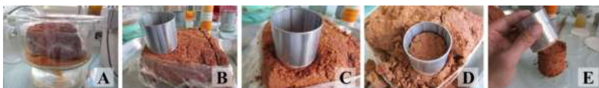
Figura 4.4 - Etapas de construção do cilindro de solo para análise de retração. A – Umedecimento do bloco de solo; B – Escolha do local para retirada da amostra; C – Início da amostragem; D – Cilindro quase finalizado para análise de retração; E – Processo final de esculptura do cilindro no bloco de solo
