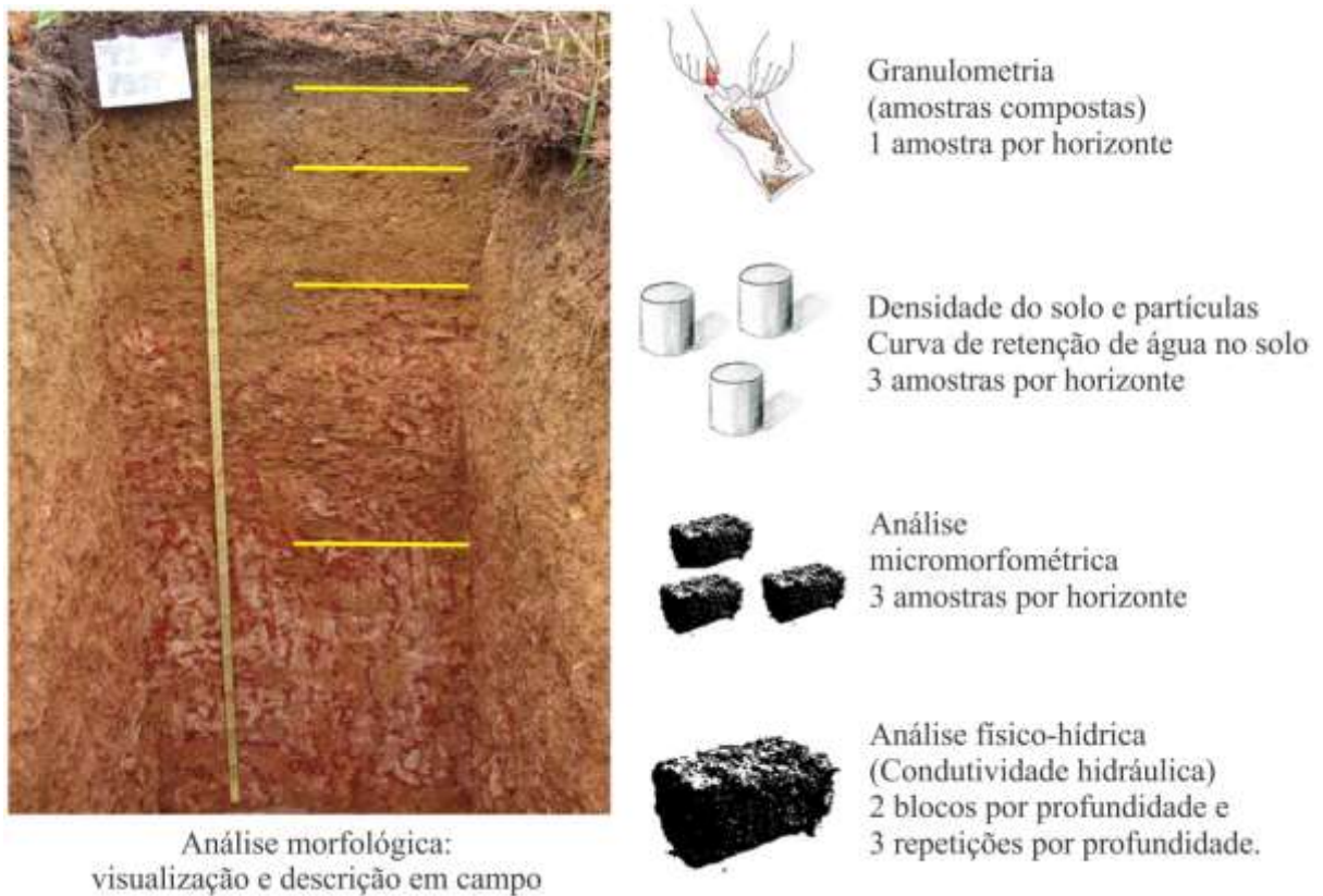
Figura 3. 1 - Esquema de coleta e amostragem do solo para análises em laboratório
