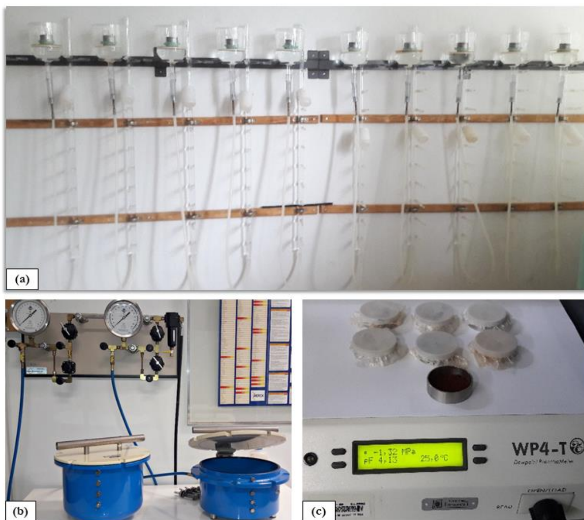
Figura 1. Equipamentos para obtenção das curvas de retenção com diferentes tipos de amostras: (a) Funis de Haines; (b) Câmaras de Pressão de Richards e (c) Psicrômetro WP4-T.
