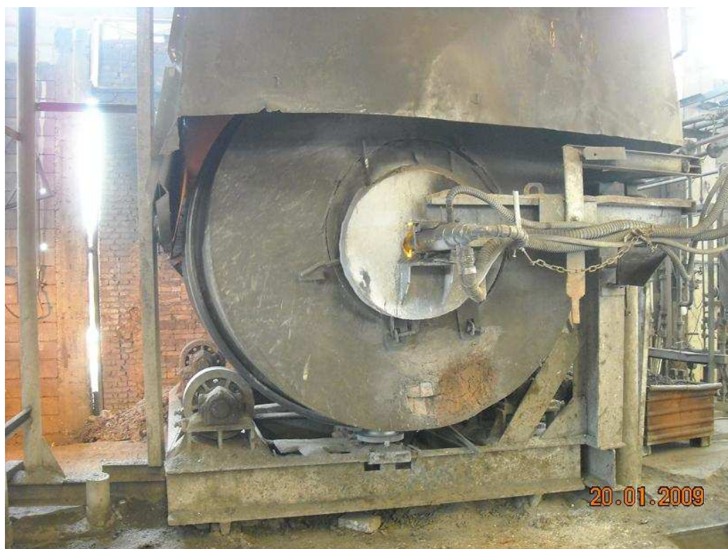
Figura 1A – Forno rotativo de fusão dos metais com fundente (Si)
