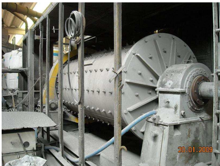
Figura 7A – Moinho de bolas onde a escória é reduzida até a granulometria de pó
