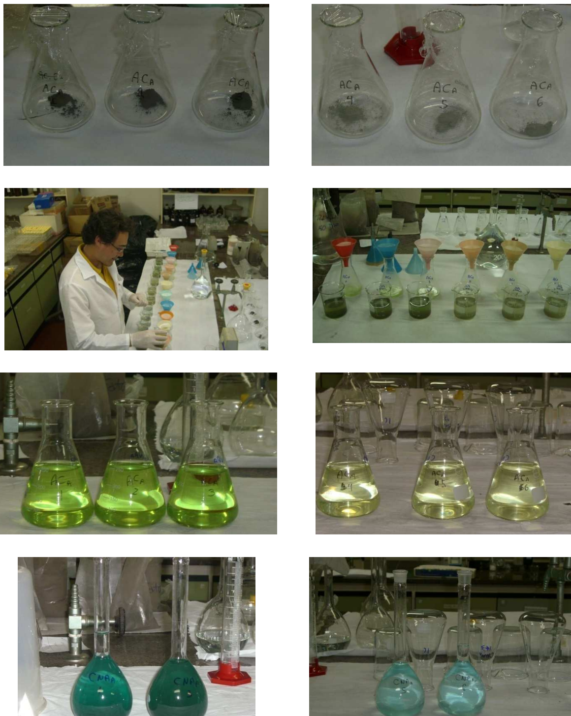
Figura 1B- Exemplo de procedimento em laboratórios para extração em ácido cítrico e CNA para os materiais A (1,2 e 3) e B (4, 5 e 6)
