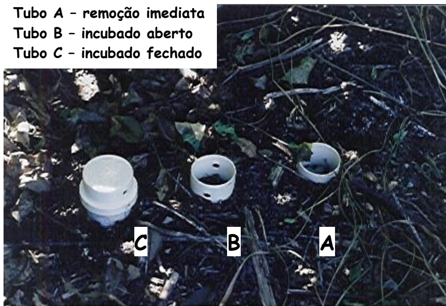
Figura 8- Tubo de PVC em solo não-degradados que recebeu 20 t ha -1 do biossólido, usado para avaliação das taxas de mineralização e de lixiviação de N in situ (março 2002)
