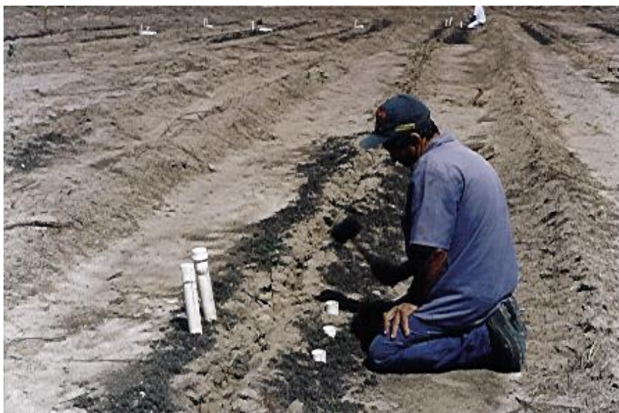
Figura 7- Instalação e retirada dos tubos de PVC para avaliação das taxas de mineralização e de lixiviação de N in situ , em solo degradado que recebeu 20 t ha -1 de biossólido
