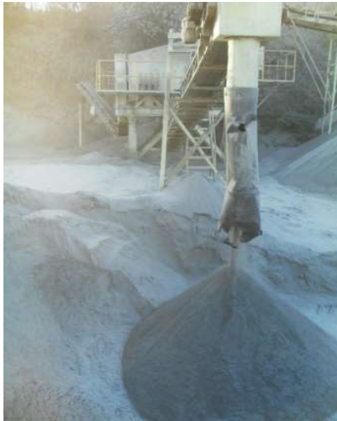
Figura 1.5 - Processo para a obtenção do remineralizador. Na parte superior da foto está o moinho com as peneiras que processam e selecionam as rochas britadas e na parte inferior o remineralizador pronto (Foto do autor)
