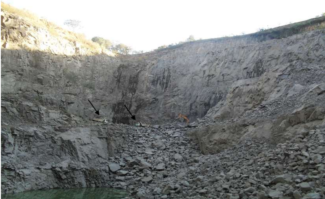
Figura 1.4 - Cava da Pedreira Cavinatto. A presença dos caminhões e da escavadeira (setas) dão noção de escala e indica a posição da frente de lavra quando da coleta das amostras para este trabalho (Foto do autor)
