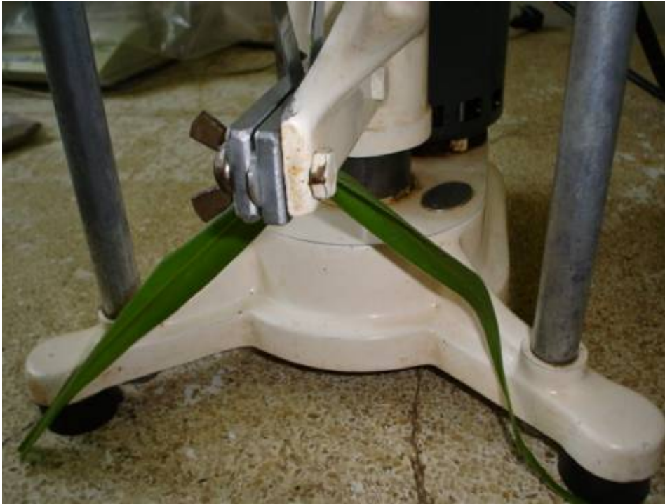
Figura 5 – Medição da resistência ao cisalhamento na folha
