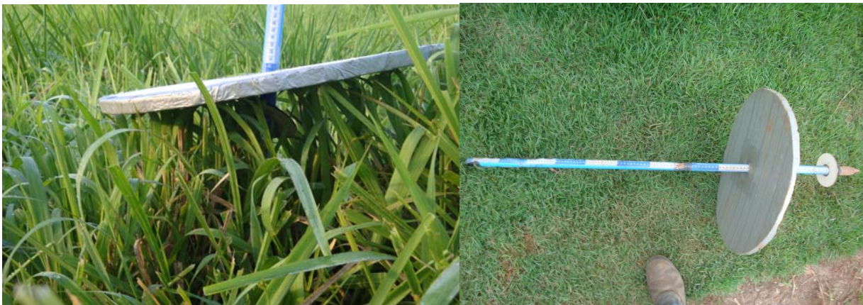
Figura 9 – Instrumento utilizado para aferição de altura
