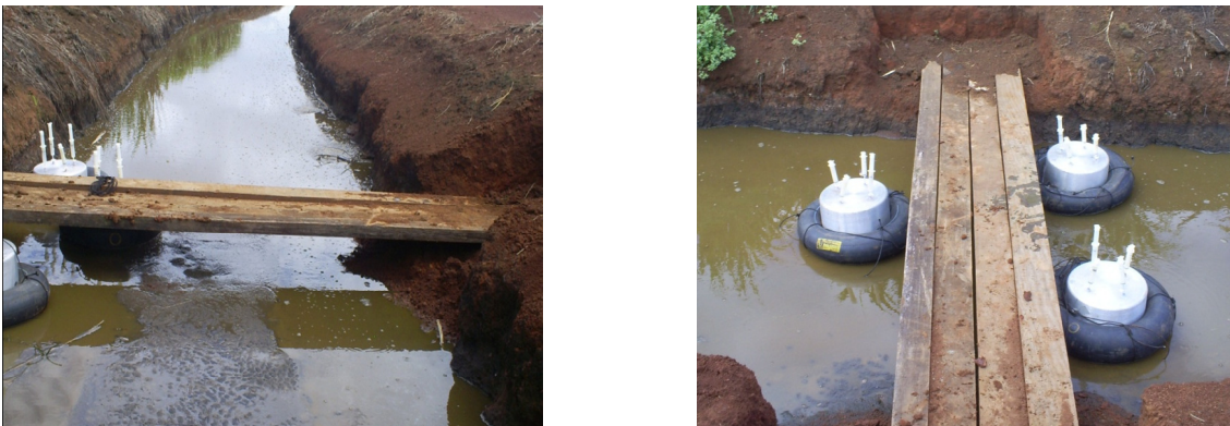
Figura 4 - Plataformas de madeira sobre o canal de distribuição de vinhaça para realização das amostragens de GEE
