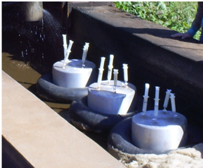
Figura 5 - Ponto de coleta de GEE na parte revestida do canal condutor de vinhaça
