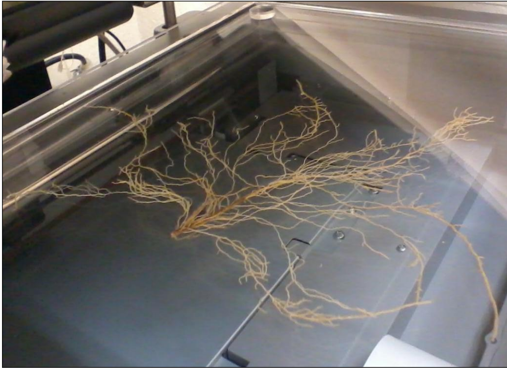
Figura 1 - Raiz de café disposta dentro da cuba com água sobre o scanner
