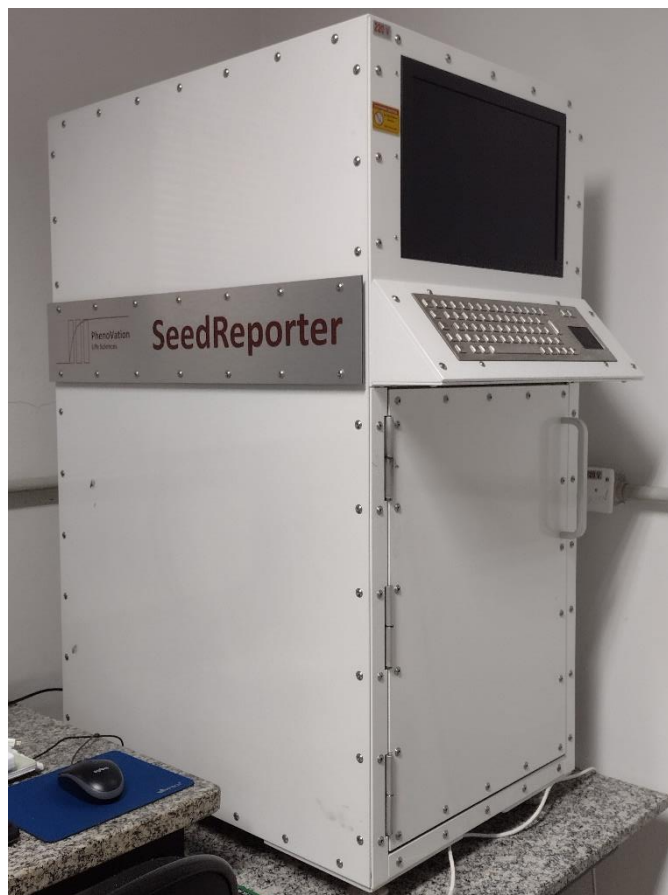
Figura 8. Equipamento SeedReporter Camera Spectral & Colour (PhenoVation Life Sciences, Wageningen, Holanda) utilizado para obtenção das imagens multiespectrais das plântulas de sálvia ( Salvia officinalis ).
