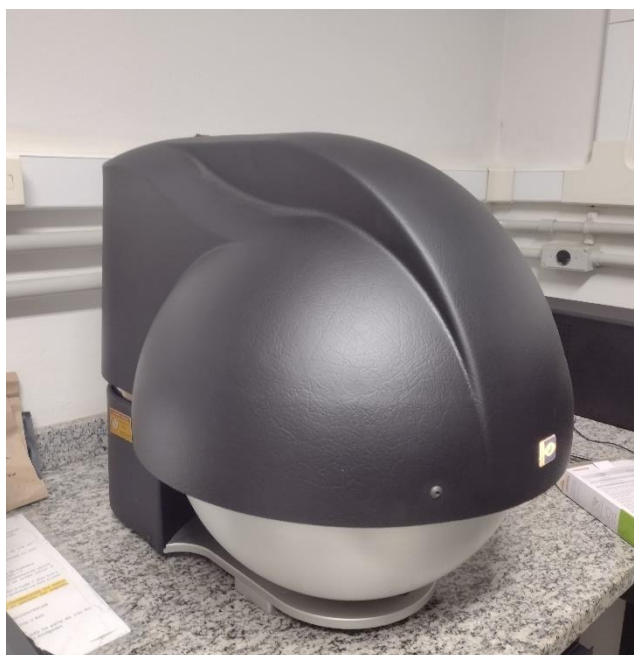
Figura 7. Equipamento VideometerLab (Videometer A/S, Dinamarca) utilizado para obtenção das imagens multiespectrais das sementes de sálvia ( Salvia officinalis ).
