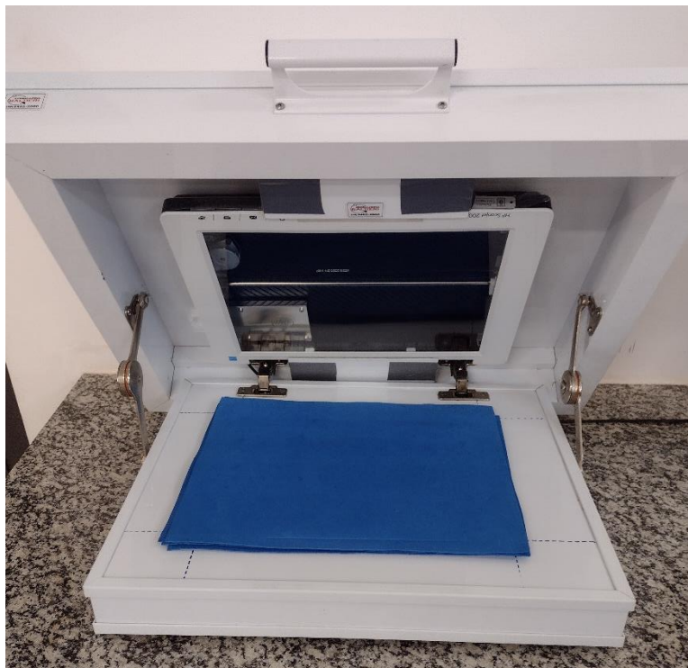
Figura 4. Equipamento para obtenção das imagens computadorizada das plântulas denominado Seed Vigor Imaging System, SVIS®.
