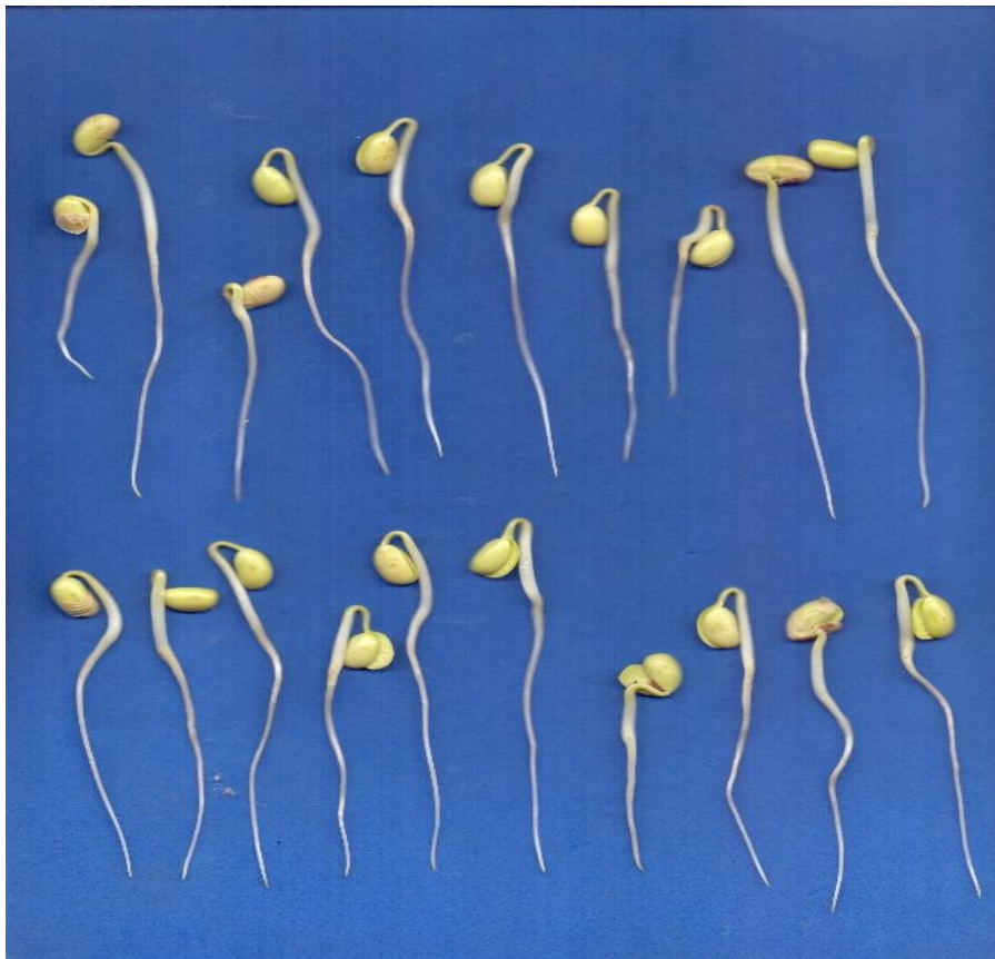
Figura 6: Imagem resultante do sistema de captura por escaneamento utilizada no software Vigor-S.
