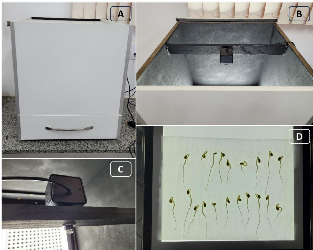
Figura 3: Equipamento de captura de imagens por transiluminação. Visão externa da estrutura de MDF (a), Visão interna do equipamento, com pintura preta fosca e câmera móvel (b) e (c), sistema de iluminação por meio de painel LED, com papel de germinação e plântulas sobre ele (d).
