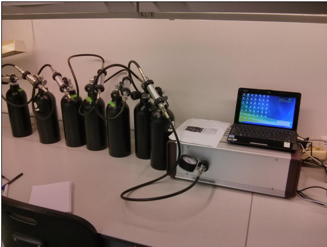
Figura 3.2 - Controlador de fluxo de pressão, monitorado por software para reduzir a pressão dos tanques de aço
