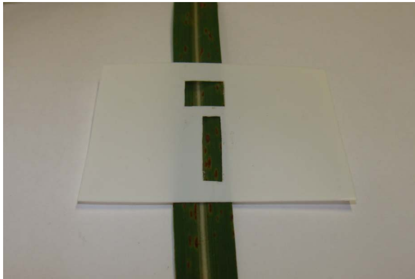
Figura 4 - Molde utilizado para quantificar a freqüência de infecção. As janelas têm área de 1 \text{ cm}^2
