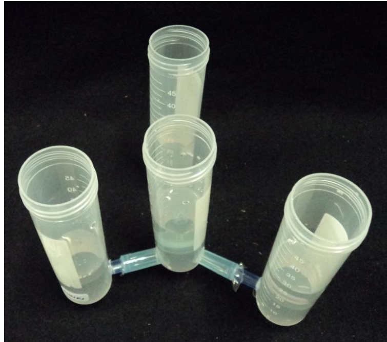
Figura 4 – Tratamentos de exsudatos radiculares de citrumeleiro Swingle, tangerineira Sunki e água destilada para a validação de um protótipo de armadilha em vista da atração de zoósporos de Phytophthora nicotianae (vista superior)
