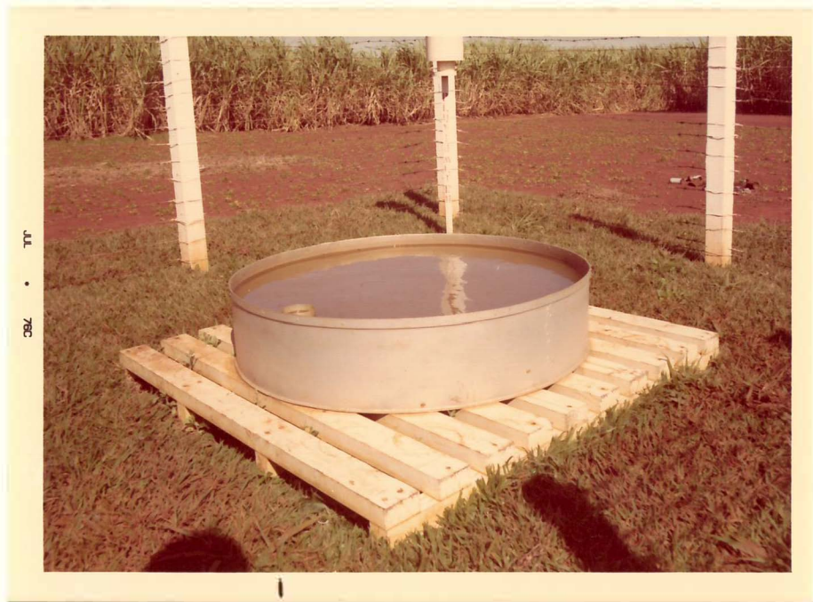
FIGURA 5 . Tanque Classe A, instalado ao lado do campo experimental.
