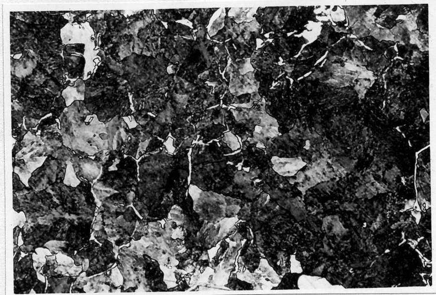
Figura 6. Micrografia da Peça Normalizada. Perlita e pequenas áreas de Ferrita em contorno de grão - 230 HV 0,1 - Estrutura de aço normalizado. Ataque Nital 145 X.
