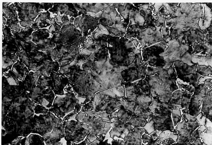
Figura 8. Micrografia da Peça Normalizada após os ensaios de campo. Perlita e áreas de Ferrita em contôrno de grão - 230 HV 0,1 - Estrutura de aço normalizada. Ataque Nital 145 X.
