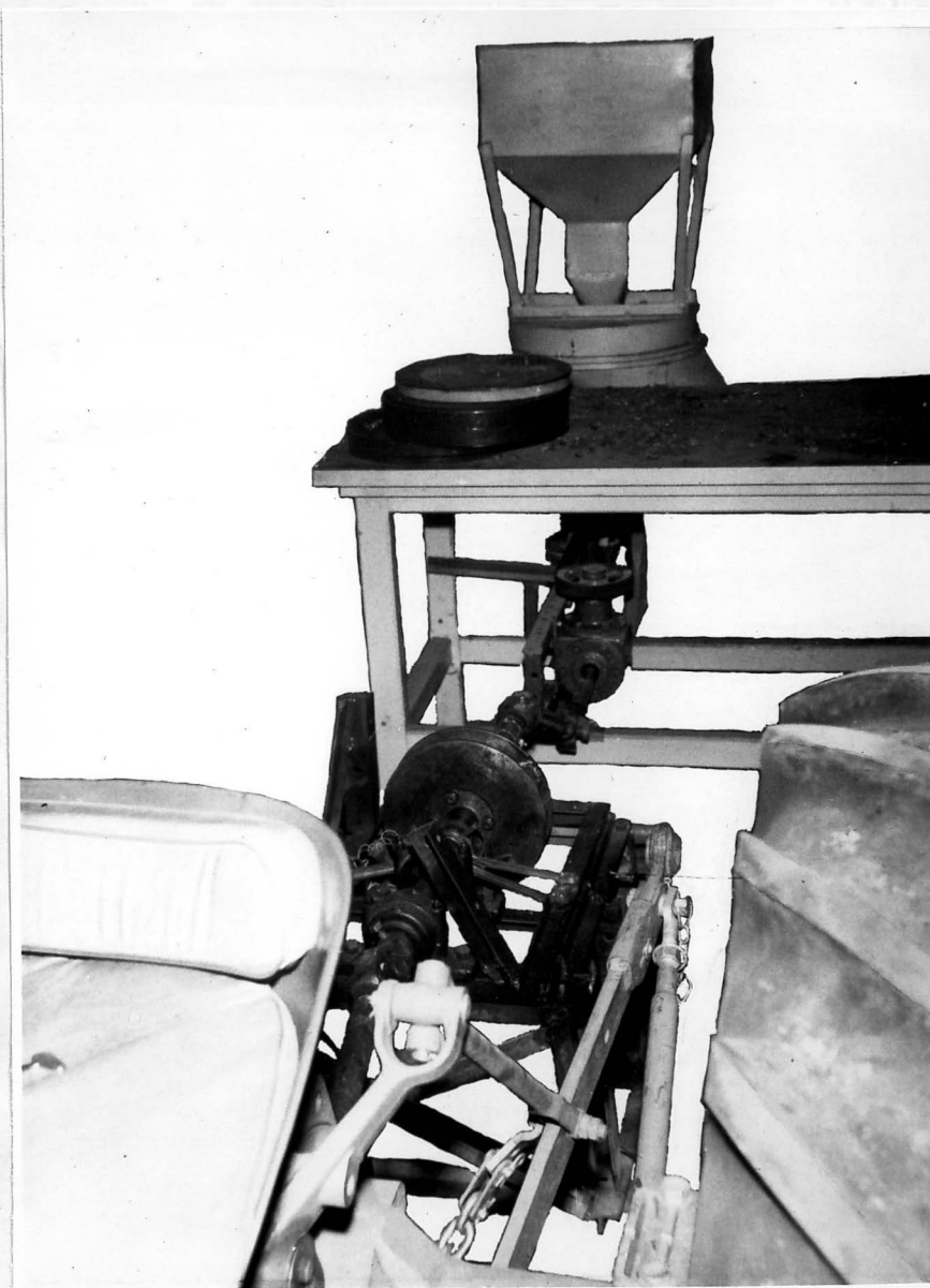
Figura 30. Aspecto da montagem para ensaio de descascamento de mamona, empregando o torçímetro eletromecânico.
