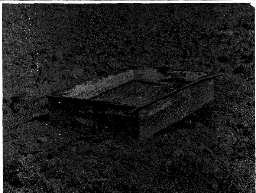
FIGURA 3 - Dispositivo de chapa de ferro para determinação da capacidade de campo do solo.
