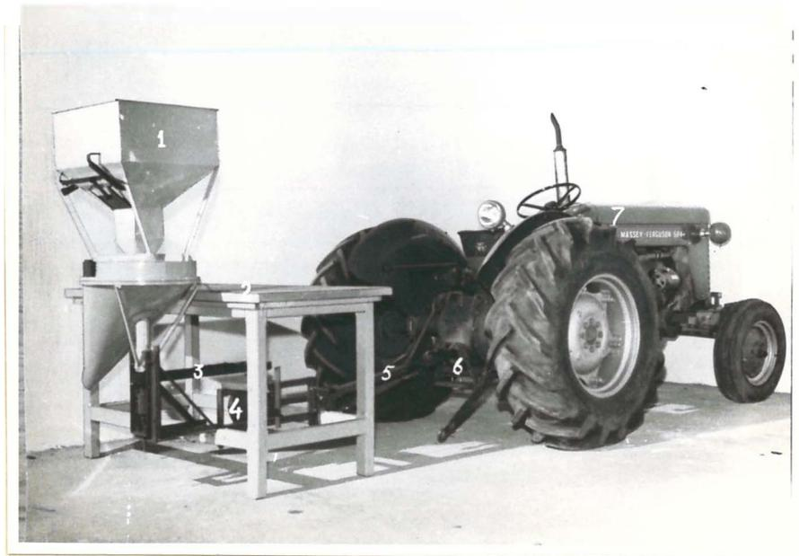
Figura 7. Conjunto experimental. Vista lateral da máquina (1), montada na bancada (2), acionada através de correias (3), caixa de engrenagens (4) e eixo cardam (5), pela TDF (6) do trator (7).
