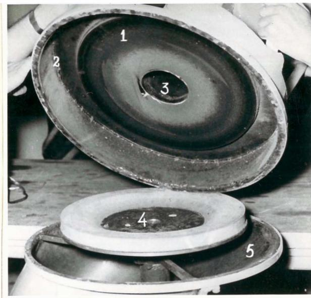
Figura 9. Mecanismo descascador mostrando a superfície descascadora fixa (1), o envoltório cilíndrico (2), o orifício central de alimentação (3), o disco móvel (4) com seu respectivo envoltório (5).
