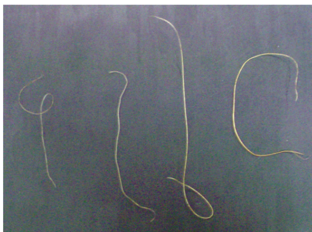
Figura 20 - Variação dimensional em fibra de coco verde, sendo: fina, médias e grossa, respectivamente. (Fonte: O AUTOR)
