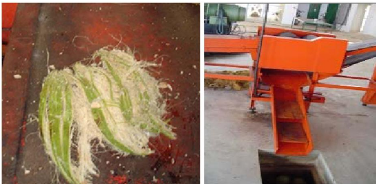
Figura 15 – a) Aspecto da matéria-prima após esmagamento; b) Calha encaminhando o LCV para a rede de esgoto (SILVEIRA, 2008)
