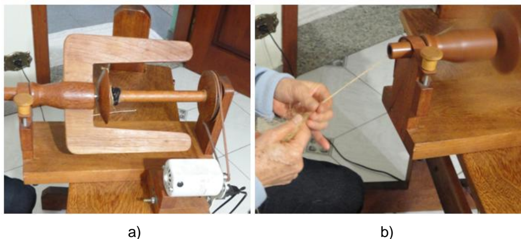
Figura 27 – a) Roca a motor; b) Estiragem e torção manual de fio de fibra de coco verde (Fonte: O AUTOR, 2013)
