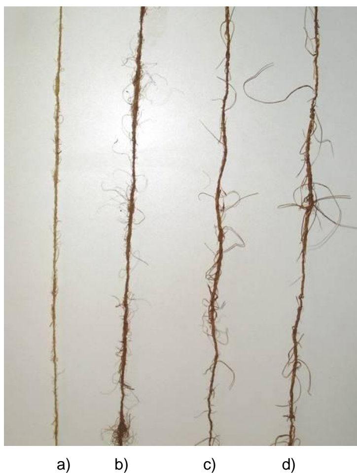
Figura 33- Fios de fibra de coco, sendo: a) fio de fibras finas tratadas; b) fio de fibras finas sem tratamento; c) fio de fibras médias sem tratamento; d) fio de fibras grossas sem tratamento. Fonte: (O AUTOR, 2013)
