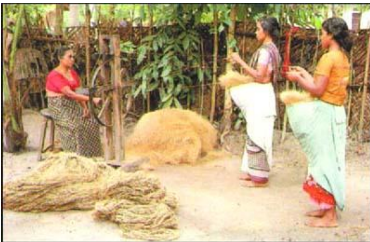
Figura 18 - Fiação manual de fibras de coco na Índia (VAN DAM, 2002)
