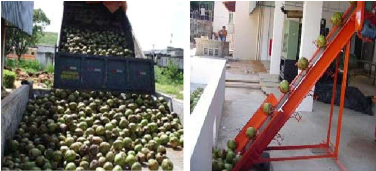
Figura 14 - a) Recebimento de matéria-prima; b) Matéria-prima sendo encaminhada pelo alimentador (casca de fibra de coco verde) (SILVEIRA, 2008)
