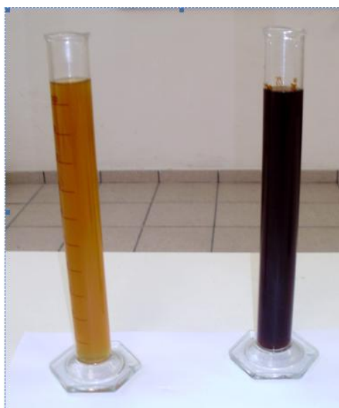
Figura 32- Efluente de purga com pré-alveamento simultâneo, e purga sem alveamento em fibras de coco verde, respectivamente. (Fonte: O AUTOR, 2013)
