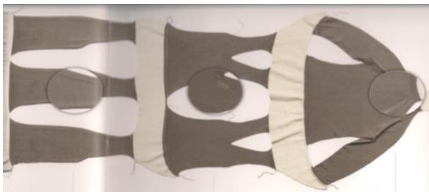
Figura 64 – Tecnologia de tecer nas máquinas as partes moldadas – fully fashioned – e sua evolução para peça pronta – Wholegarment . Fonte: Stoll, 1990.
