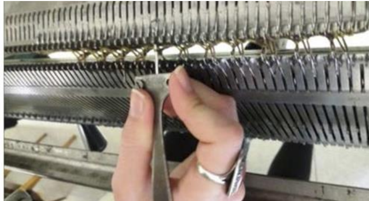
Figura 17 – Instrumento para transferência de pontos entre as agulhas na máquina manual industrial. Pulsão de transferência de pontos em método manual. Fonte: Laura Piccinini, IUAV, 2015
