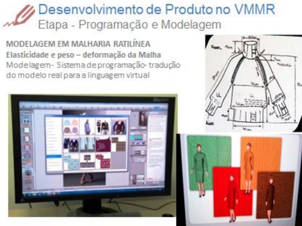
Fig. 36 – Modelagem detalhada e escolha de tecido e textura, peso e ponto. Fonte: STOLL, 2010.
