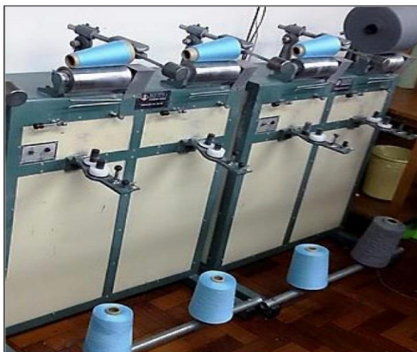
Figura 5 – Máquina de parafinar o fio, chamada espuladeira. Fonte: Malharia Gita, 2014.
