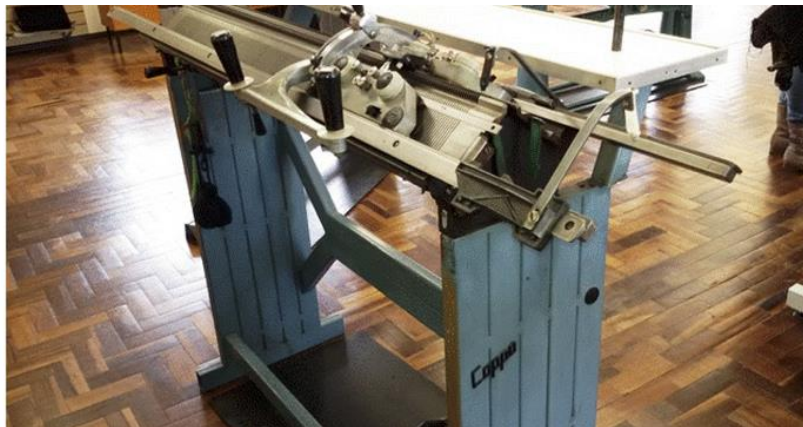
Figura 12 – Máquina de Malharia Manual da Universidade de Caxias do Sul. Fonte: UCS, 2014.
