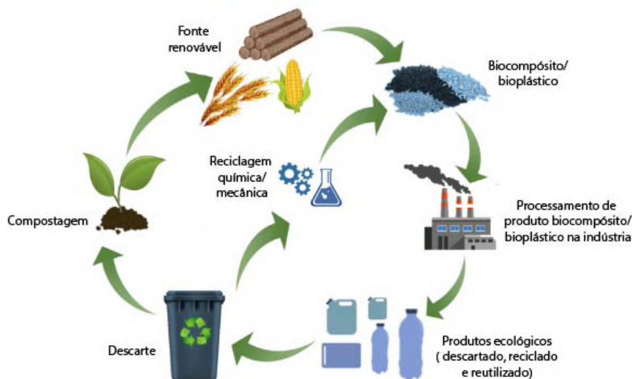
Figura 22. Processo de reciclagem de biocompósitos
