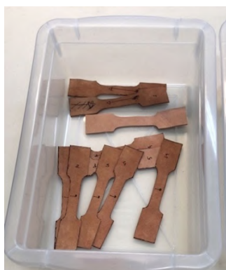
Figura 30. (a) Amostras de couro caprino prontas para o teste no dinamômetro (b) Couro de caprino com indicação do sentido longitudinal, parte dorsal do animal
