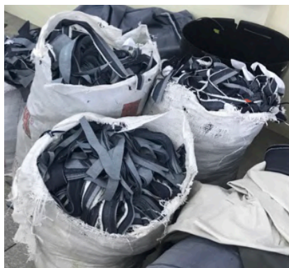
Figura 58. Resíduos de jeans coletados do processo de corte do tecido (jeans 100% algodão junto com jeans 97% algodão e 3% de elastano)
