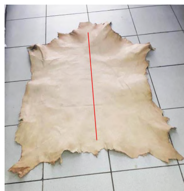
Figura 30. (a) Amostras de couro caprino prontas para o teste no dinamômetro (b) Couro de caprino com indicação do sentido longitudinal, parte dorsal do animal
