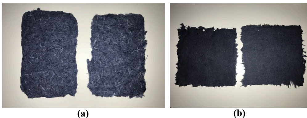
Figura 61. Materiais biocompósitos empregando: (a) resíduos de jeans desfibrado (16x20 cm); (b) e resíduos de jeans em pó (20x20 cm)
