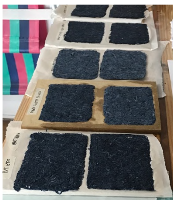
Figura 31. Camadas do biocompósito de resíduo de jeans desfibrado aguardando secagem após preparação
