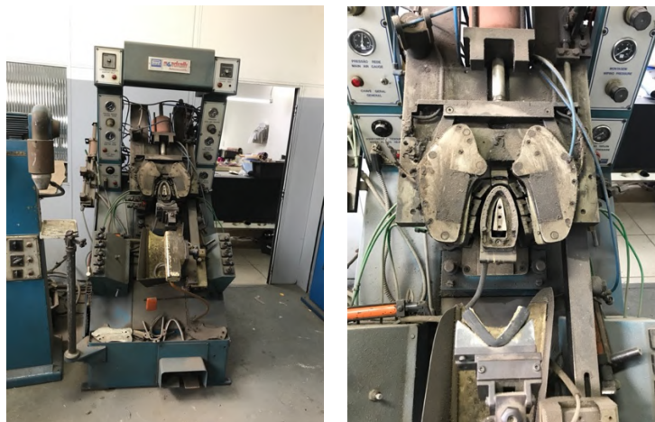
Figura 43. Máquina de montagem do bico do calçado da fábrica I
