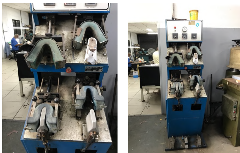
Figura 45. Máquina de conformar contraforte e biqueira da fábrica I
