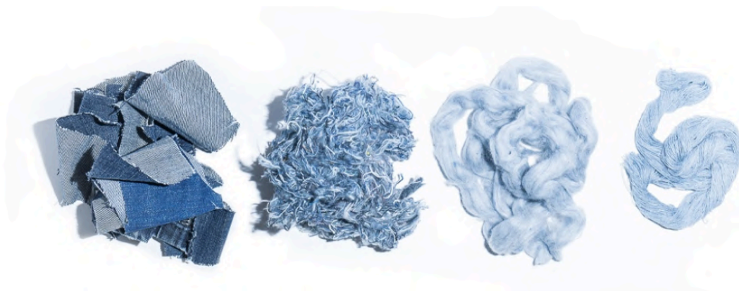
Figura 60. Processo de reciclagem do jeans: do tecido ao fio
