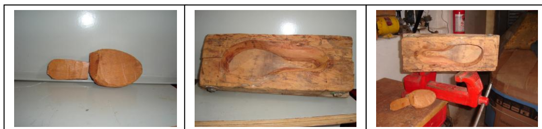
Figura 66 - Forma macho-fêmea para solado-protótipo. (Fonte: O AUTOR, 2012)
