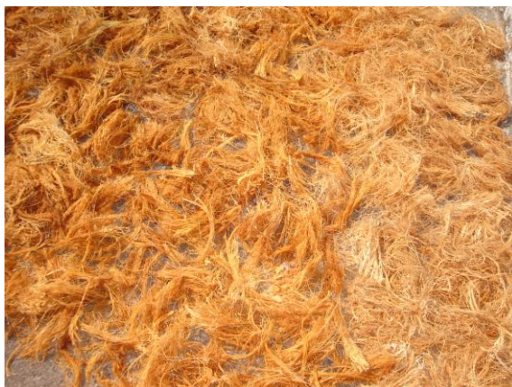
Figura 63 - Fibras de coco depois de lavadas e secas ao ar livre, \pm 25^{\circ}\text{C} . (Fonte: O AUTOR, 2012)
