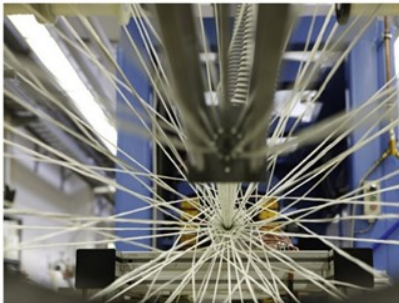
Figura 6: Detalhe dos filamentos trançados
