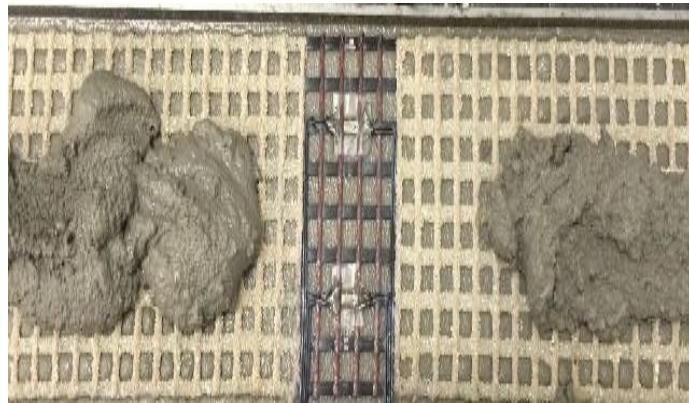
Figura 22: Processo de moldagem das placas para o ensaio de flexão
