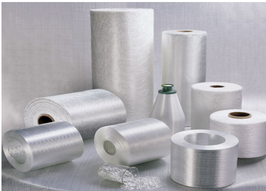
Figura 16: Exemplos de fios, pavios, mantas, véus e tecidos usados nos compósitos
