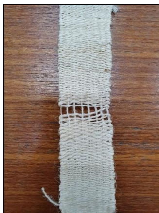
Figura 67 - Exemplo de uma amostra que não rompeu após ensaio de Tração
