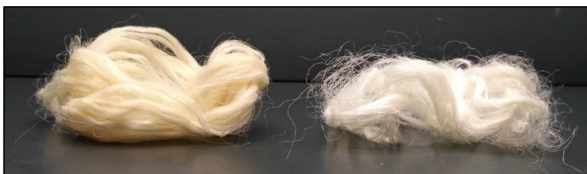
Figura 63 - Fibra de tucum em cru e após tratamento de branqueamento.
