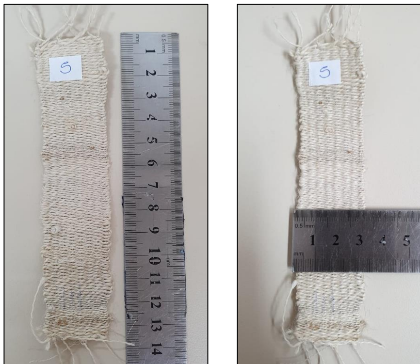
Figura 35 - Medidas sendo tiradas na Amostra 5. (a) Comprimento; (b) Largura.
