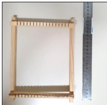
Figura 30 - Tear manual utilizado para a confecção do tecido plano.
