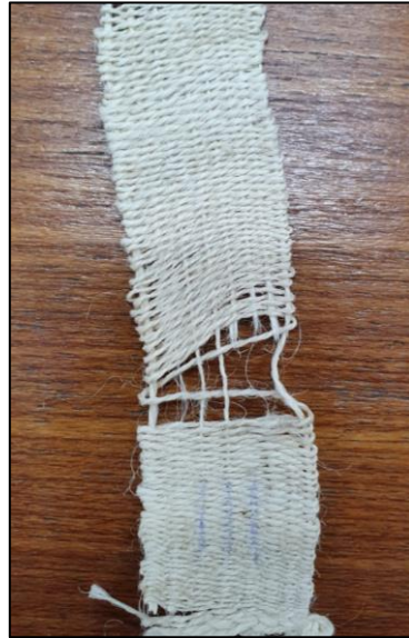
Figura 68 - Exemplo de uma amostra que rompeu após ensaio de Tração
