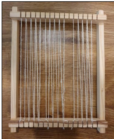
Figura 32 – (a) Tear com fios de urdume; (b) Primeira tira confeccionada
