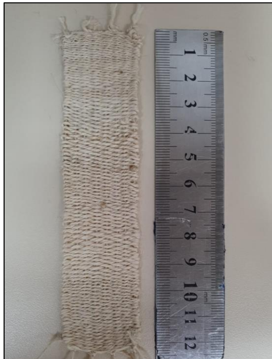
Figura 34 - Detalhe da amostra de tecido plano de urdume e trama 100% tucum
