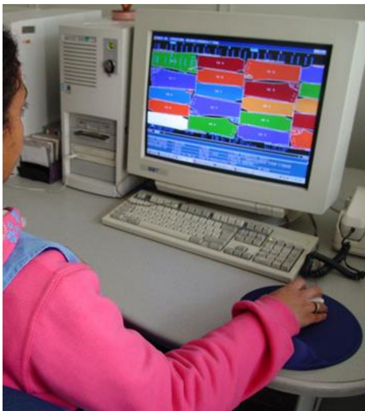
Figura 4 – Estudo de encaixe pelo sistema CAD
