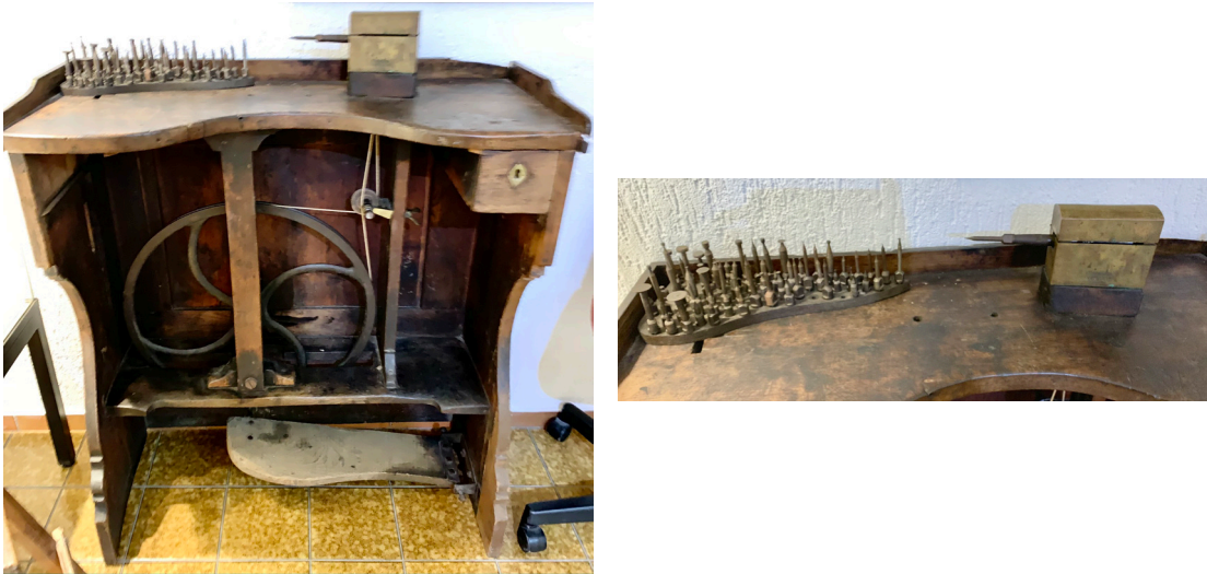
Figura 14 – À esquerda, uma mesa de gravação antiga, acionada pela movimentação do pé, o torno horizontal, as brocas e as fresas. À direita, o torno, as brocas e as fresas.
