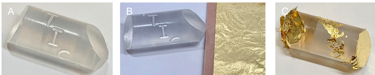
Figura 63 – A: Peça polida e pronta para a aplicação da folha de ouro 24K. B: Cilindro e a folha de ouro 24K. C: A folha de ouro aplicada ao cilindro.
