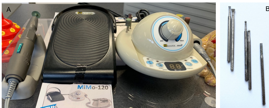
Figura 34 - A: Micromotor de até 35.000 rotações por minuto; B: Fresas diamantadas de diversas formas (cônica invertida, esfera, cilíndrica) e granulações (de grossa a fina).
