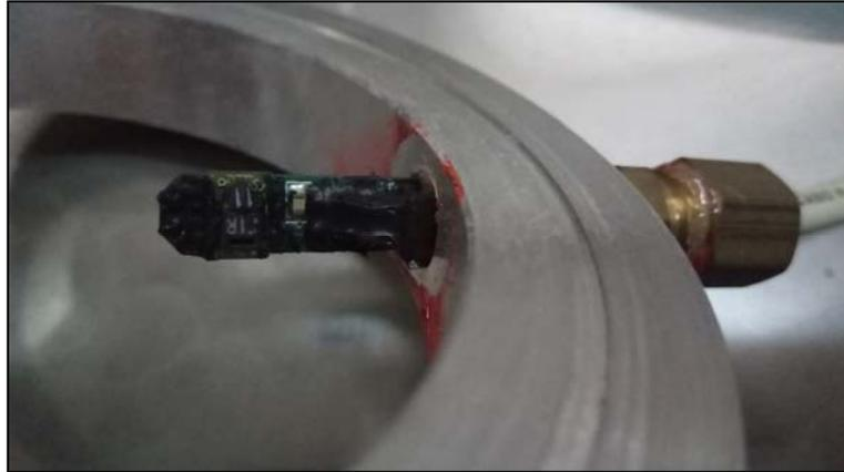
Figura 27 - Sonda de temperatura e umidade SMTEX
