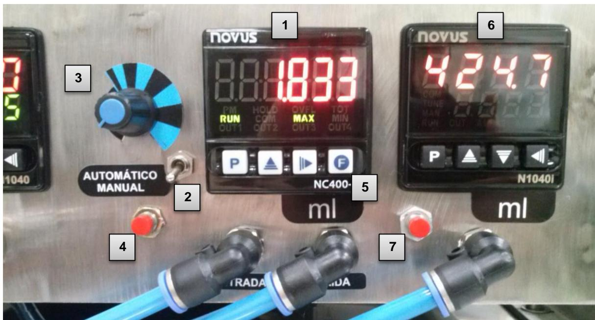
O indicador (1) mostra o volume em ml de líquido deslocado do reservatório para o interior do corpo principal. Para acionar o bombeamento existem duas opções que podem ser selecionadas pela chave (2) para acionamento automático controlado pelo controle (3) ou manual acionado pelo botão (4). O valor pode ser zerado através do botão 'F' (5)
