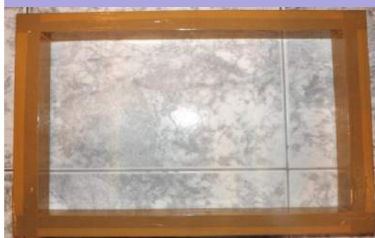
Moldura com o acabamento de fita adesiva
